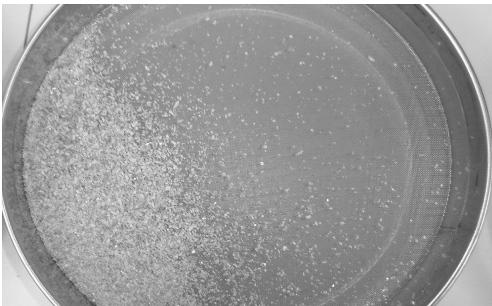
KUVIO 12 Leukavälillä 5 mm murskattua ja seulottua kiviainesta. Partikkelikoko on 0,5–2,0 mm eli koeajoissa tavoitteena olevaa kokoa. Kuvassa kiviaines on seulan päällä (kuva: Juho Pietarila 2012).
