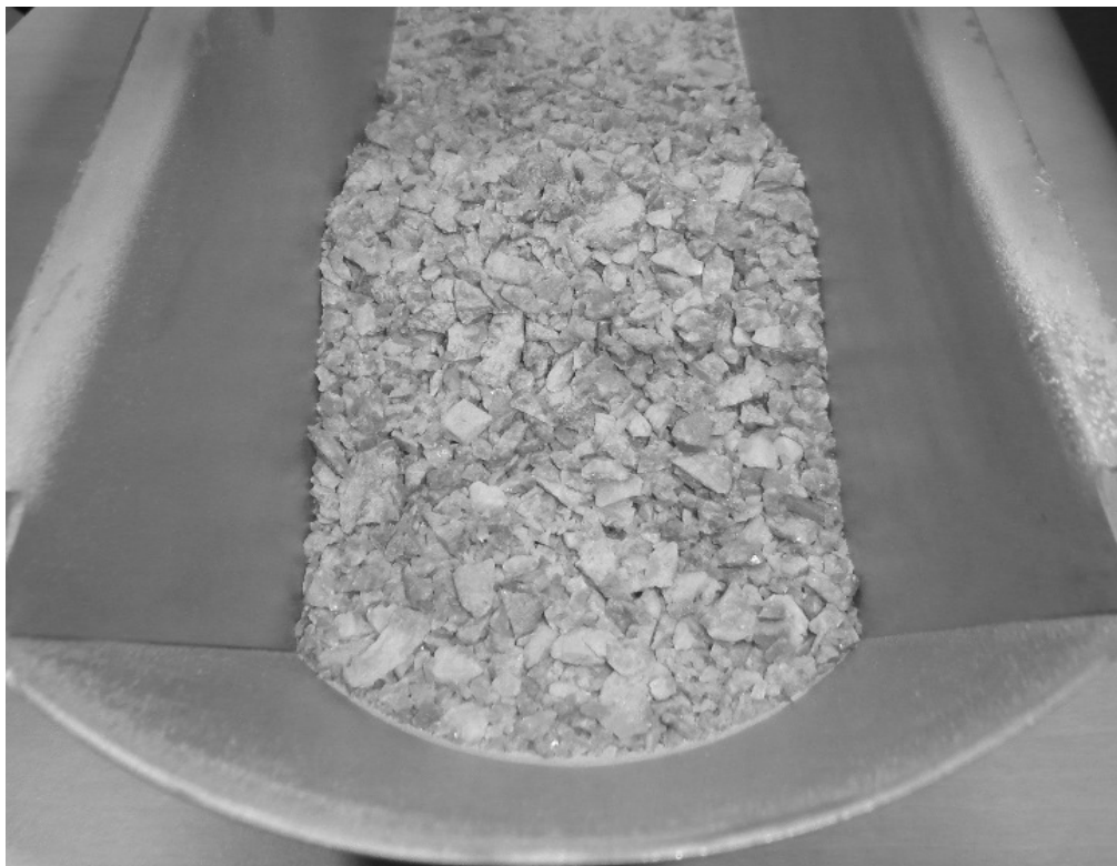
KUVIO 11 Leukavälillä 5 millimetriä murskattua kiviainesta. Kiviaines on kuvassa murskaimen tuotteen keräimessä. (kuva: Juho Pietarila 2012.)
