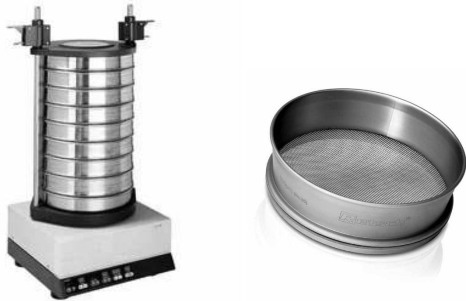
KUVIO 8 Laboriomittakaavaan tarkoitettu seulasarja, tärytin ja yksittäinen seula. (Retsch. Sieve Shakers 2012.)
