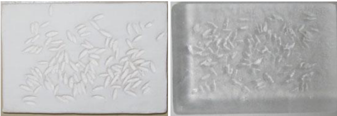
Kuvasarja 5. Onnistunut muotti ja muotista saatu lasilaatta
