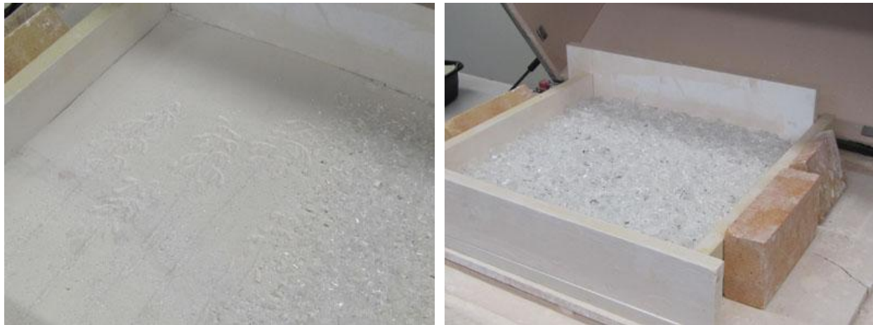
Kuvasarja 8. Lasimurskan laittaminen muottiin
