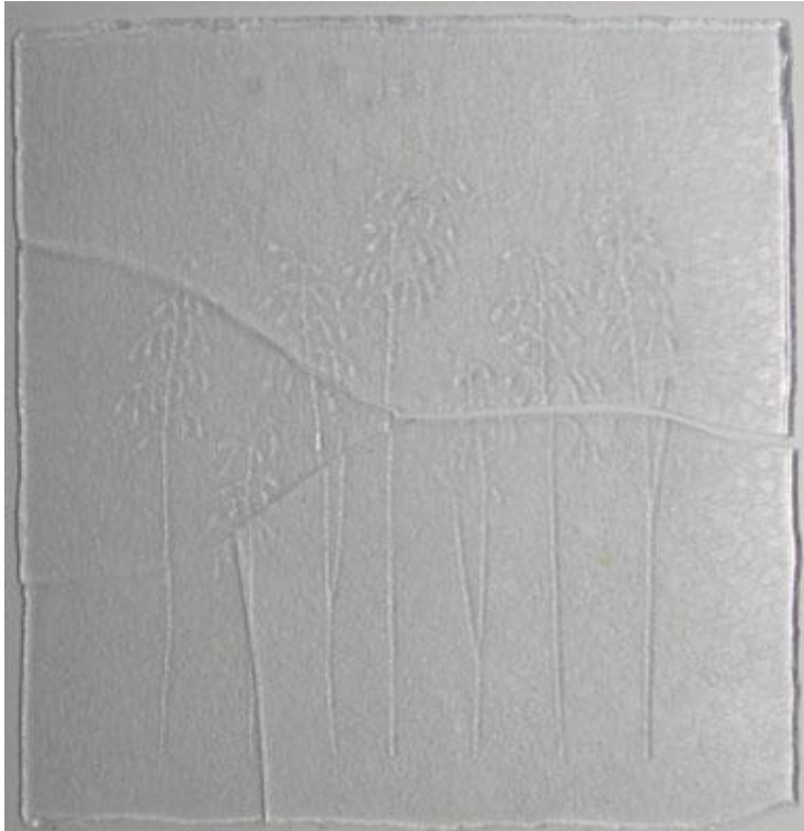
Kuva 21. Lasilaatta halkesi neljään osaan muotoon sulatuksessa, koska lämpötila laski liian nopeasti alas
