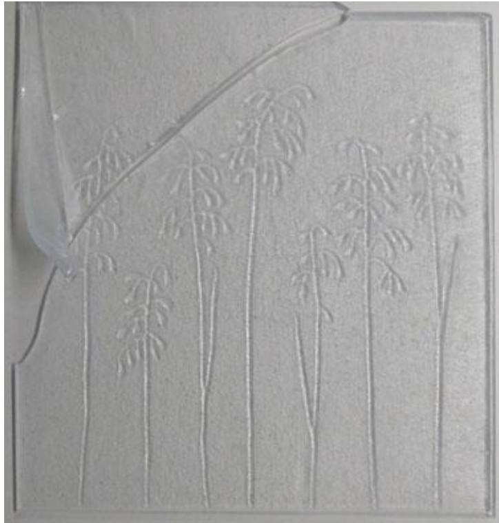
Kuva 22. Lasilaatta meni rikki, koska uunilevy oli liian pieni
