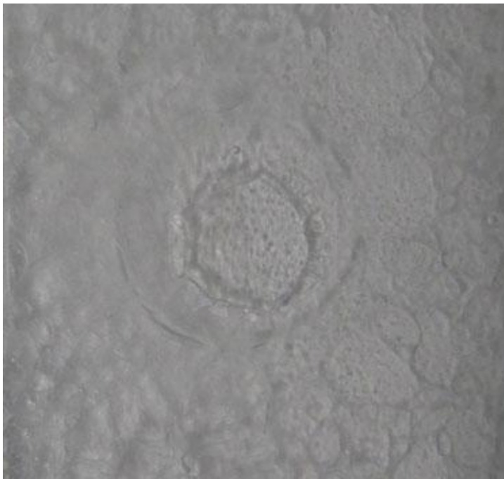
Kuva 18. Lasissa ollut reikä on jättänyt ympyrän
