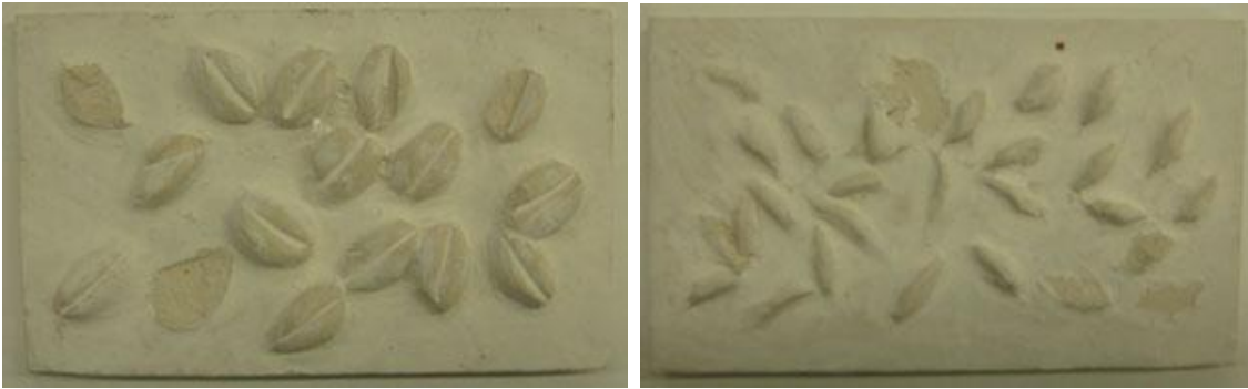
Kuvasarja 4. Ei päästäviä muotteja, muotit rikkoutuneet
