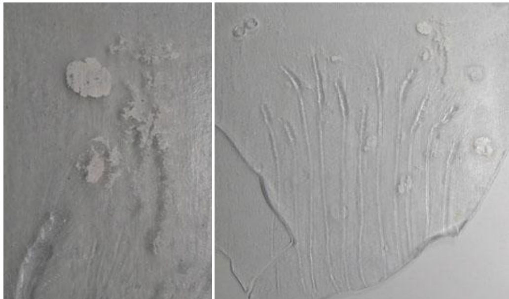
Kuvasarja 11. Uunipesu jäänyt kiinni lasiin
