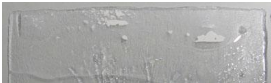
Kuva 17. Rajoitin kaatui lasin päälle kesken polton, jätti painaumajäljen ja jälkiä uunipesusta.
