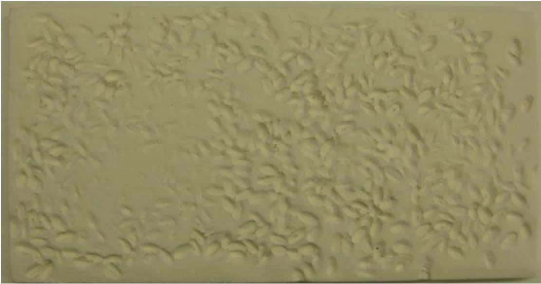
Kuva 8. Koemuotti, jota on jouduttu hiomaan paljon. Osa kuvioinnista on hävinnyt.
