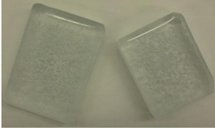
Kuva 10. Lasimurskaa sulatettu jyvien päälle. Ne ovat jättäneet hieman kuviointia lasiin.
