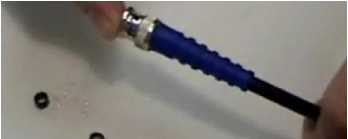
Kuva 28. Valmis BNC-liitin kiinnitettynä koaksiaalikaapeliin [23].
