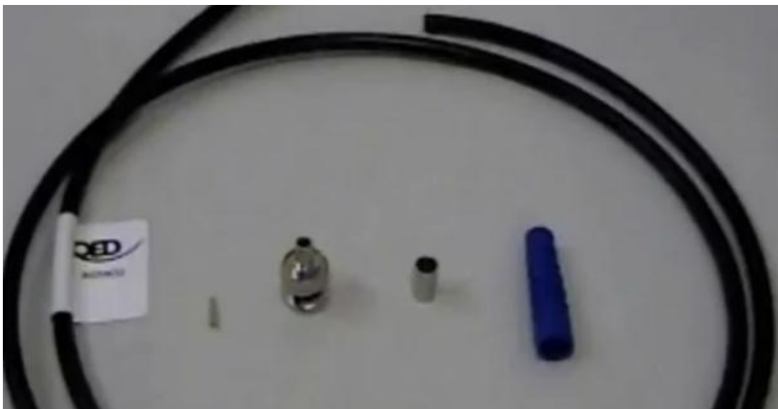
Kuva 24. Koaksiaalikaapeli ja BNC-liittimen osat [23].
