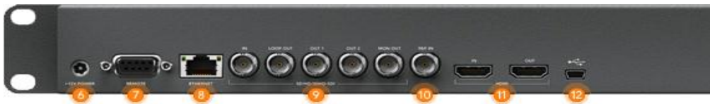
Kuva 19: Testausympäristössä käytössä olevan HyperDeck Studion liitännät [17].
