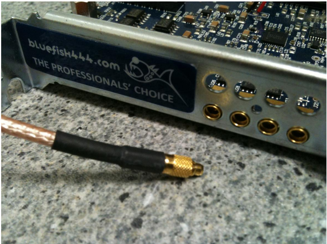
Kuva 9. Bluefish Epoch Horizon -videokortin minikoaksiaaliliittimet.
