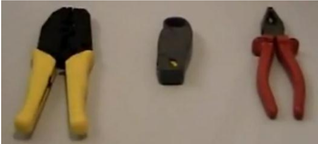
Kuva 23. BNC-liittimen ja koaksiaalikaapelin yhdistämiseen vaadittavat työkalut [23].
