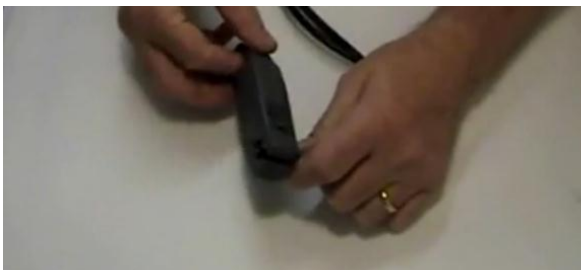
Kuva 25. Koaksiaalikaapelin pään leikkaaminen [23].
