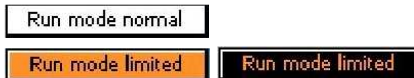
KUVA 4.4; Limited run mode; Rajoitettu ajotila -tilailmaisim on valkeana, kun käyntitilan avain on normaaliasennossa. Rajoitettu käynti vilkkuu musta-oranssina, kun rajoitettu käyntitila on aktiivinen.
