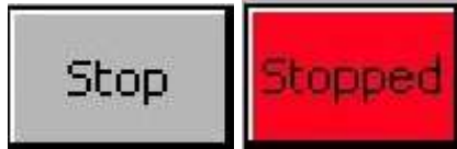
KUVA 5c; Stop remote–painike, syttyy punaiseksi kun laite on seistilassa ja sammuu kun kone on käyntitilassa.
