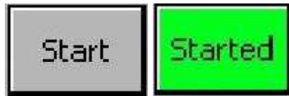
KUVA 6b; Start – painike syttyy vihreäksi, kun laite on käynti-tilassa ja sammuu kun kone on seis-tilassa.
