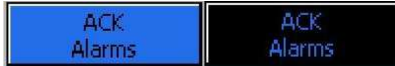
KUVA 3.3.1b; Hätäseis-piirissä on aktiivinen vika, joka tulee eliminoida ennen hätäseis-piirin kuitaamista.
