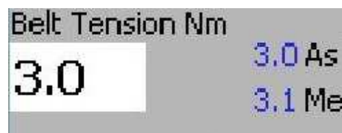
KUVA 5.1b; Hihnatensio, asettaa halutun tension hihnojen puristusvoimalle.
