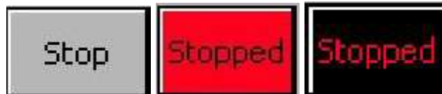
KUVA 5.2b; Stop local – paikallisohjauspainike, toiminto on muuten sama kuin etäohjaustilassa, mutta seis-tieto vilkkuu musta-punaisena.
