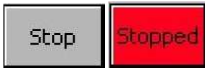
KUVA 4b; Stop – painike, syttyy punaiseksi kun laite on seis-tilassa ja sammuu kun kone on käynti-tilassa.
