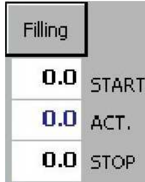
KUVA 7.2g; Filling – geelin täytön aktivointipainike sekä raja-arvojen syöttökentät.
