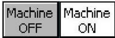
KUVA 3.4b; Laite on valittava aktiiviseksi. Valitsematon laite ei kytkeydy päälle, eikä myöskään anna hälytystä.
