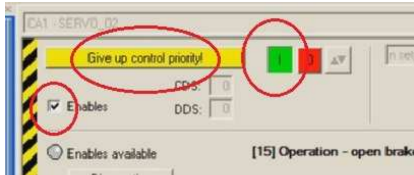
KUVA 8.3f; [x]Enables –valinta ja käynnistys –painike.
