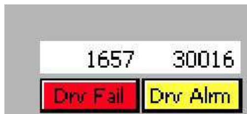
KUVA 3.3.2a; Moottorikäyttöjen hälytykset ja virheilmoitukset.
