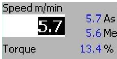
KUVA 4.1; Nopeusasetus. Näyttää asetetun ja mitatun nopeuden, sekä moottorin momentin.
