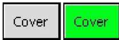
KUVA 5.4a; Cover – painike, suojakansi ylhäällä, palaa painike keltaisena. Suojan ollessa alhaalla, palaa painike vihreänä.
