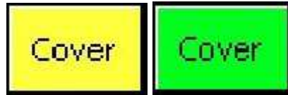
KUVA 4.3a; Cover – painike, suojakansi ylhäällä, jolloin painike palaa keltaisena. Suojan ollessa alhaalla, painike palaa vihreänä.
