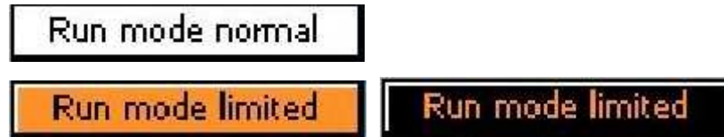
KUVA 5.5; Limited run mode; Rajoitettukäynti -tilailmaisoin on valkeana, kun käyntitilan avain on normaalitilassa. Rajoitettukäynti vilkkuu musta-oranssina, kun rajoitettukäyntitila on aktiivinen.
