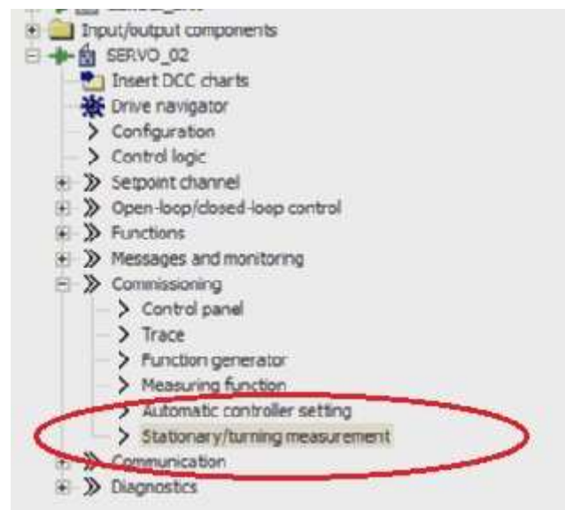
KUVA 8.3a; Stationary measurements –identifiointoajo paikallaan suoritettuna.
