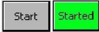
KUVA 5b; Start remote – etäohjauspainike, painike syttyy vihreäksi, kun laite on käyntitilassa ja sammuu kun kone on seistilassa.
