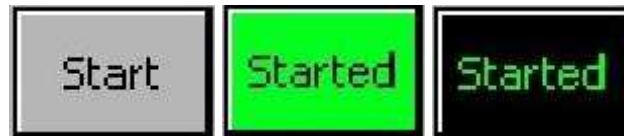
KUVA 5.2a; Start local – paikallisohjauspainike, toiminto on muuten sama kuin etäohjaustilassa, mutta käyntitieto vilkkuu musta-vihreänä.
