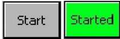
KUVA 4a; Start – painike syttyy vihreäksi kun laite on käynti-tilassa ja sammuu kun kone on seis-tilassa.
