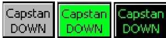
KUVA 4.2a; Vetolaite ylös -painonappi. Alhaalla valo on harmaana. Ylös liikuttaessa se vilkkuu musta-vihreänä 9 sekunnin ajan.
