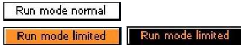
KUVA 6.5; Limited run mode; Rajoitettu käynti -tilailmaisina on valkeana, kun käyntitilan avain on normaalitilassa. Rajoitettu käynti vilkkuu musta-oranssina, kun rajoitettu käyntitila on aktiivinen.
