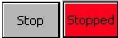
KUVA 6c; Stop – painike syttyy punaiseksi, kun laite on seis-tilassa ja sammuu kun kone on käynti-tilassa.
