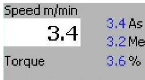
KUVA 6.1a; Nopeusasetus. Näyttää asetetun ja mitatun nopeuden, sekä moottorin momentin.
