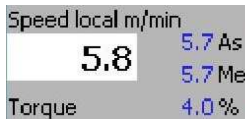
KUVA 5.1a; Nopeusasetus. Näyttää asetetun ja mitatun nopeuden, sekä moottorin momentin.
