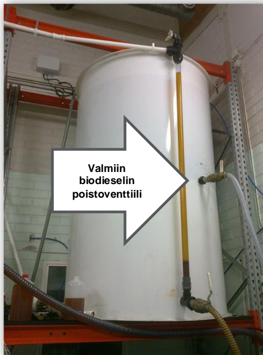
Kuva 8. Valmiin biodieselin poistovenntiilin sijainti.
