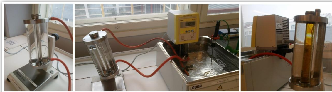
Kuva 11. Kuulaviskosimetrin valmistelu mittaukselta varten.
