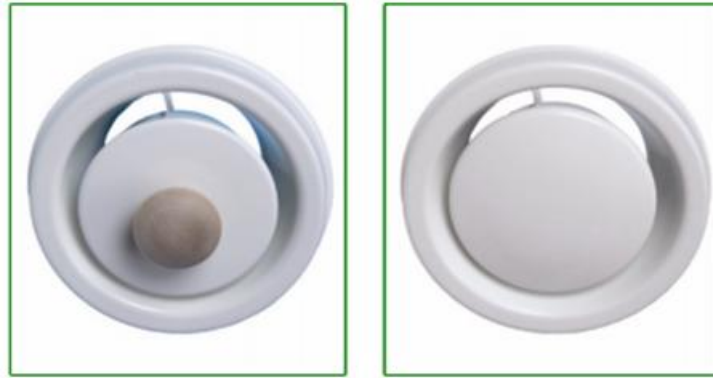
Kuva 12. Fläkt Woods Oy:n KSO-sarjan poistoilmaventtiileitä. Vasemmalla saunan löylytiloihin tarkoitettu KSOS, ja oikealla perusmalli KSO. Molemmat venttiileistä soveltuvat myös savukaasujen kuristimiksi.
