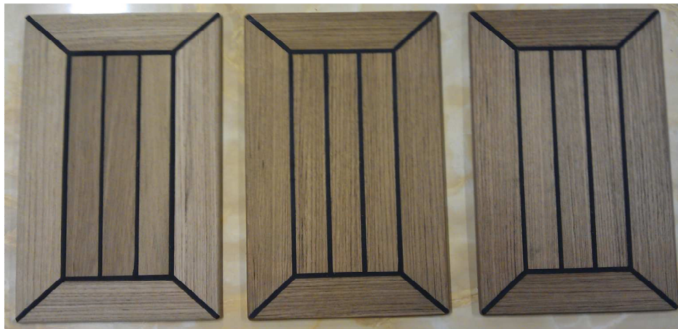
KUVIO 26. Sääräsitustestin koekappaleet testauksen jälkeen. Vasemmalla on tiikki, keskellä havuplytiikki ja oikealla öljytty havuplytiikki.
