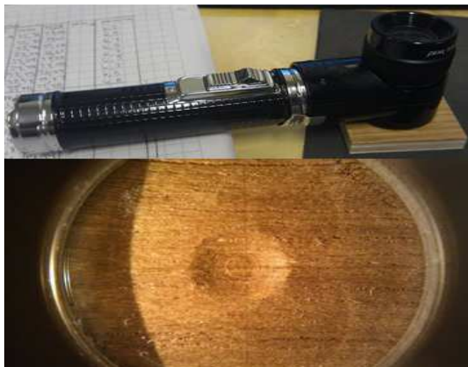
KUVIO 15. Brinell-testissä koekappaleeseen muodostuneen painuman halkaisija määritettiin ylempänä näkyvällä aparaatilla. Kuvassa alempana on näkymä linssin läpi katsottuna.
