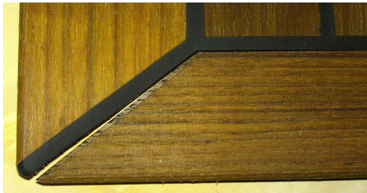
KUVIO 22. Tiikkikappaleen pitkien sivujen päät irtosivat lyhyiden sivujen päistä heti ensimmäisen kosteutuksen aikana
