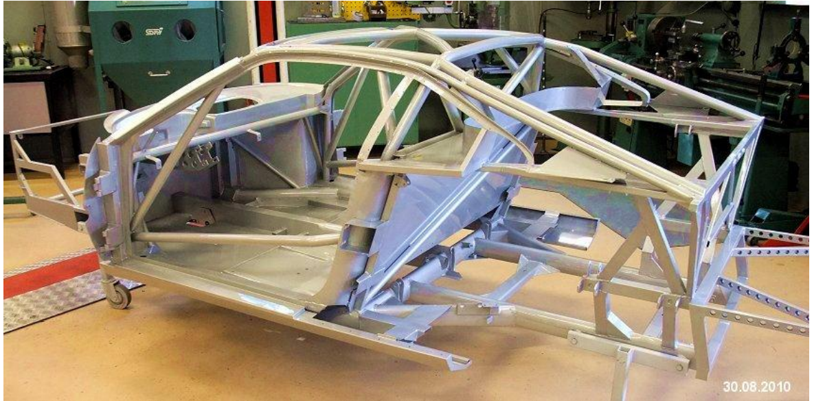
Kuvio 2. Ferrari 308 GTB runko- ja turvakaarirakenne (Mäkelä Auto Tuning).
