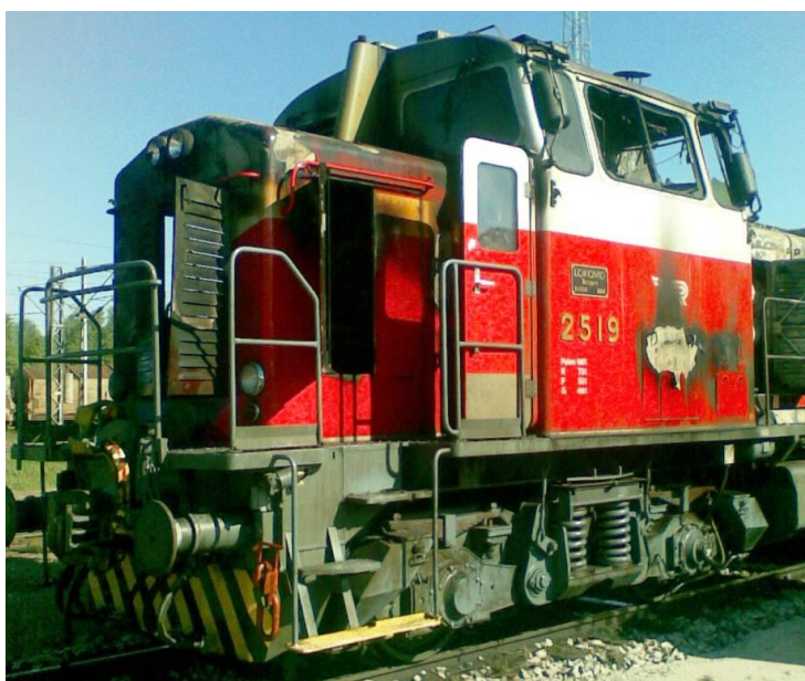
Kuva 13. Palanut Dv12 veturi, Paloturvallisuus ja evakuointi
