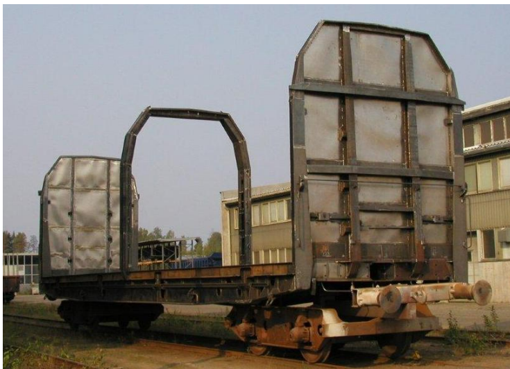
Kuva 5. Siirtoseinävaunun, Sim, runko siirtoteleillä, Rakenne ja mekaaniset osat
