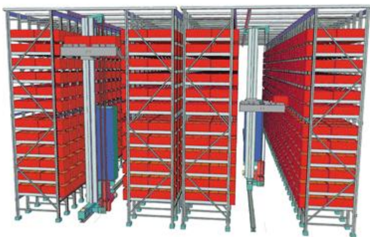
Kuva 5. Miniload-automaattivarasto (META:n www-sivut 2012)
