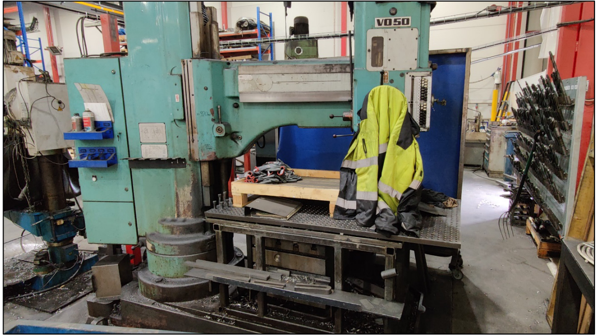
Kuva 30. Vastakkaisen työpisteen epäkuntoinen säteisporakone.
