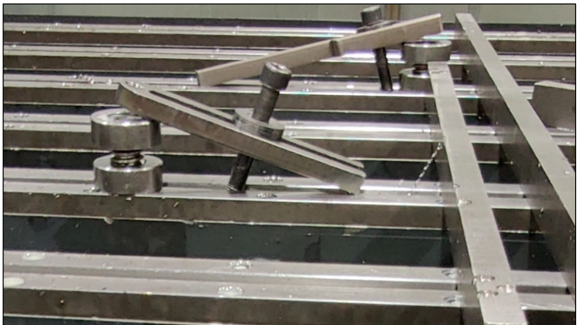
Kuva 47. Kuvassa portaattomasti säädettävä vastepala, avokiinnitysrauta ja kiilarauta.
