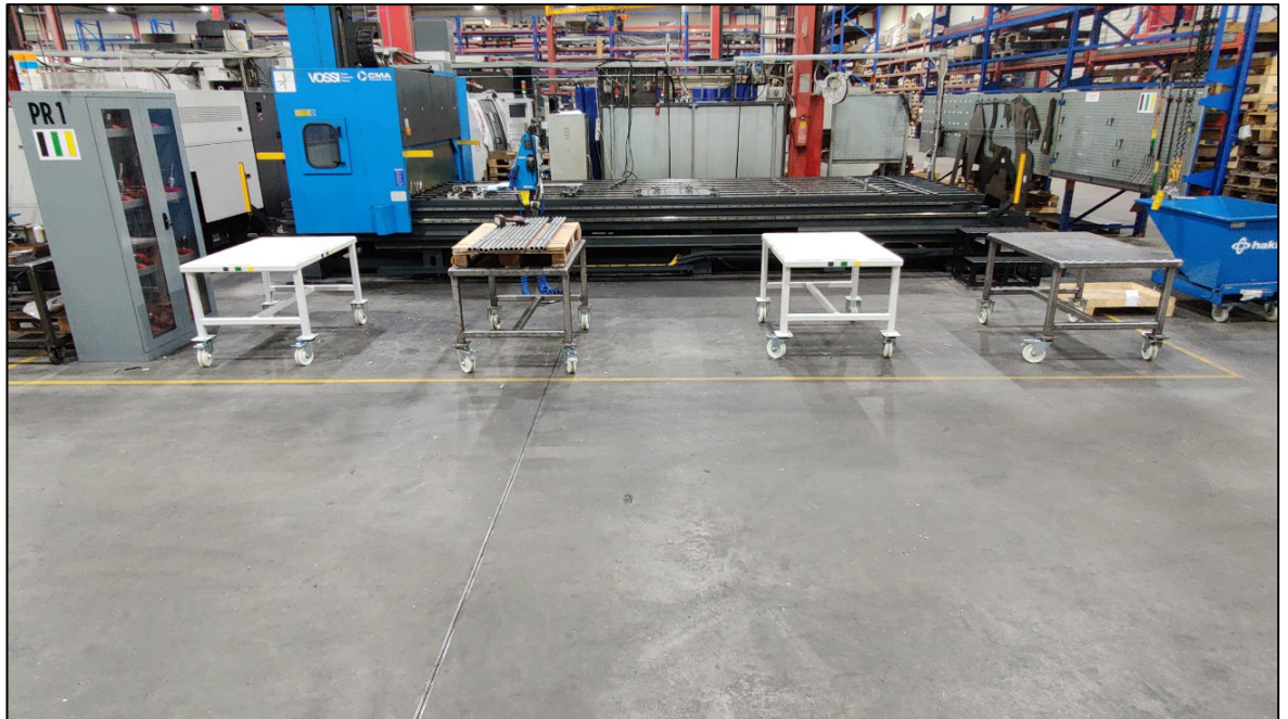
Kuva 26. CMA-porauskeskuksen uudet lavapöydät.
