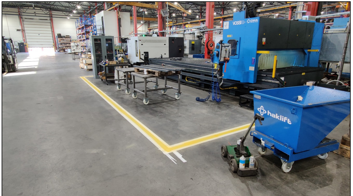
Kuva 58. Työpisteelle maalattu erotusviiva.
