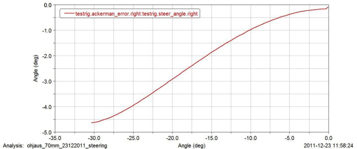
Kuvio 12. Oikean eturenkaan Ackermann-virhe suhteessa vasemman renkaan kääntökulmaan.
