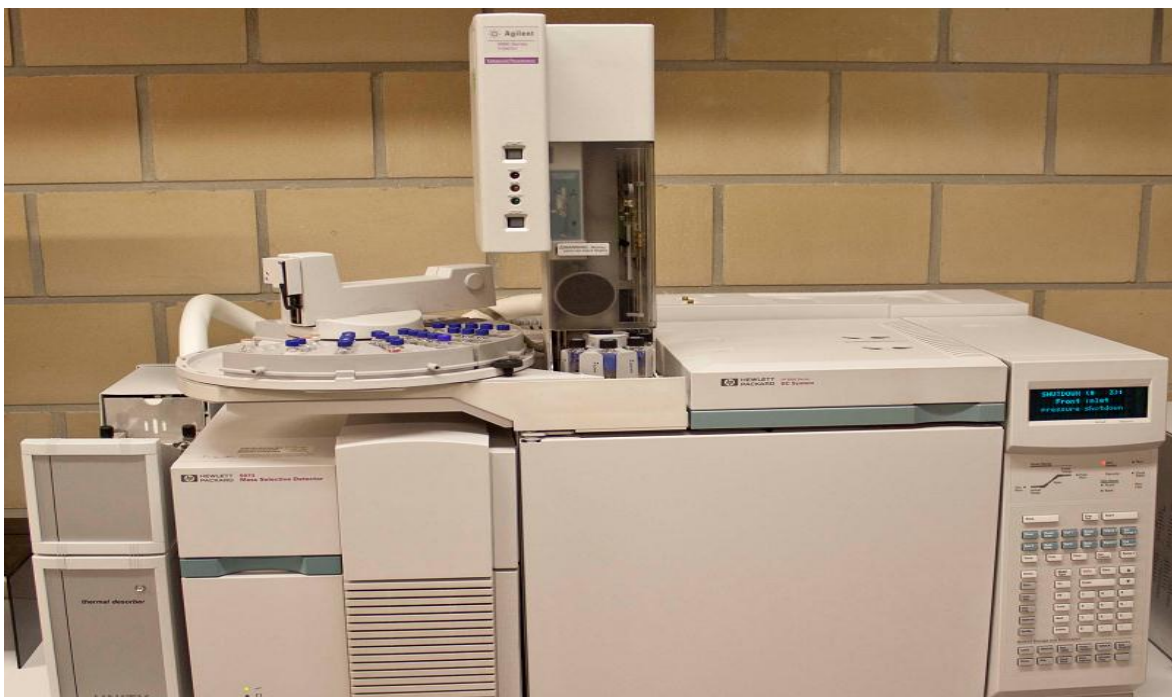
GC-MS-TD-laitteisto GC: HP 6890 MS: HP 5973
