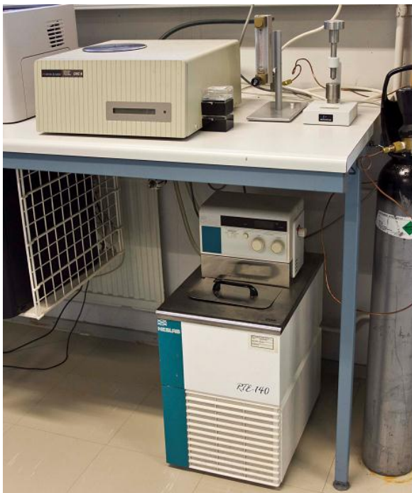
DSC-laitteisto: Perkin Elmer Differential Scanning Calorimeter, DSC 6 Jäähdytін: Neslab RTE-140
