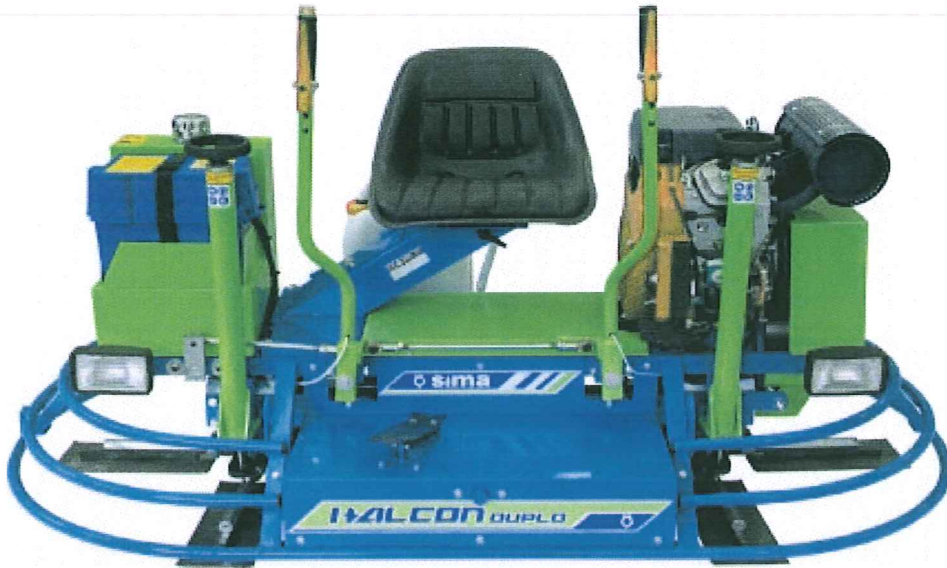
Kuva 11. Päältä ajettava hierontokone (muokattu 12.2.2012.)
