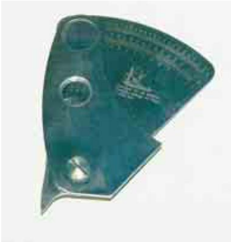
Kuva 10. a- mitan mittaustulkki, mittausalue 0-15 mm tarkkuus 0,1 mm.
