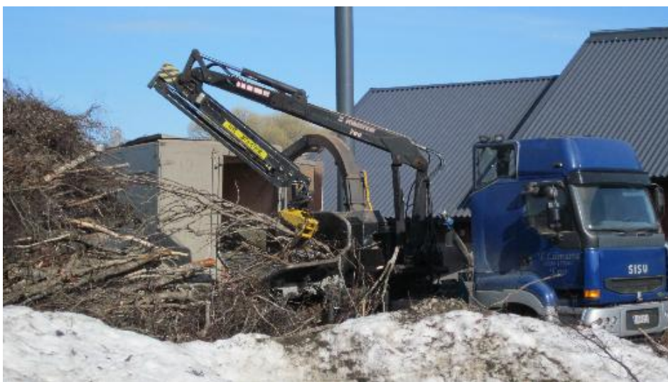
Kuva 4. Hakkuriauto hakettamassa kokopuuvarastoa. Taustalla hakkeenkuljetusauto takaperin sekä lämpölaitos. (Kuva: Jyry Eronen)
