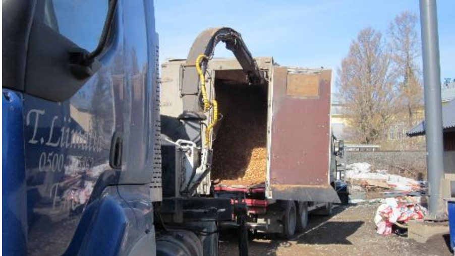
Kuva 6. Hakkeen puhallus kuljetusauton konttiin takaoven kautta. (Kuva: Jyry Eronen)
