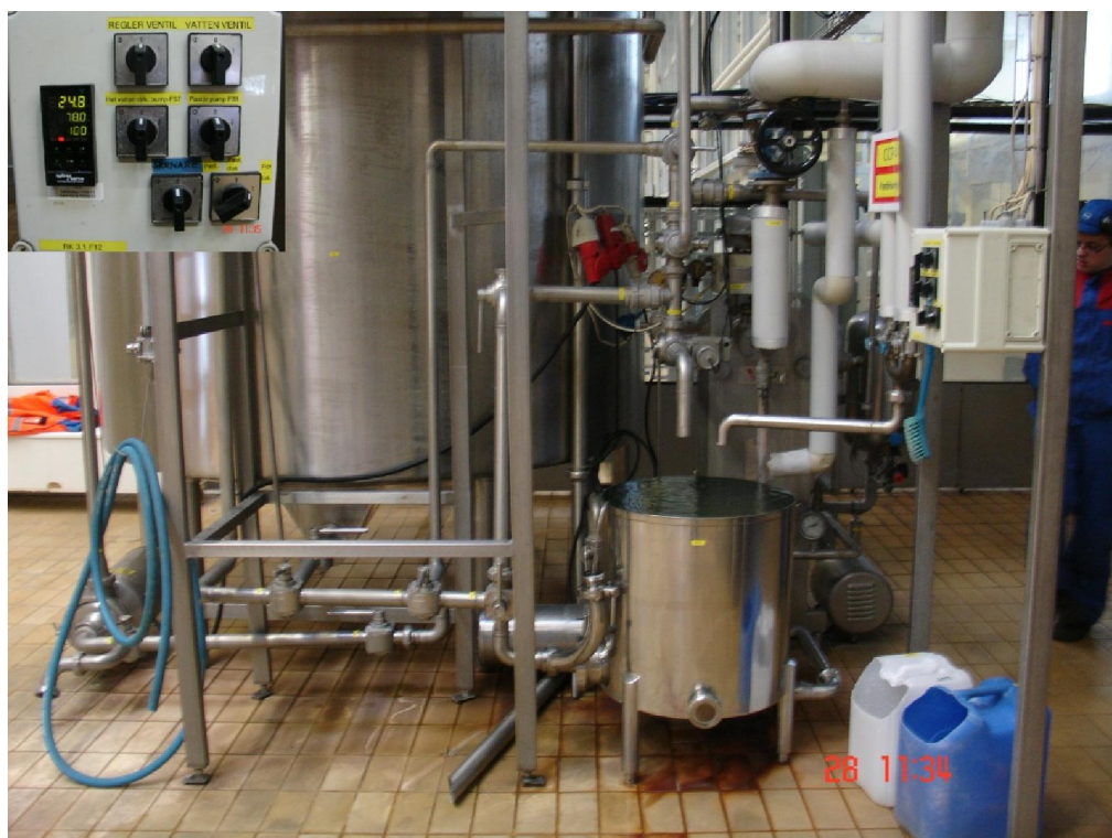
Figur 12: Pastöriseringstanken och dess disksystem, diskstyrningen uppe till vänster, kemikaliedoseringsdunkar nere till höger.
