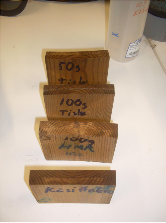
KUVA 12. Keittokoekappaleita 4 tunnin keiton jälkeen. Kuva Anssi Koivumäki 2012
