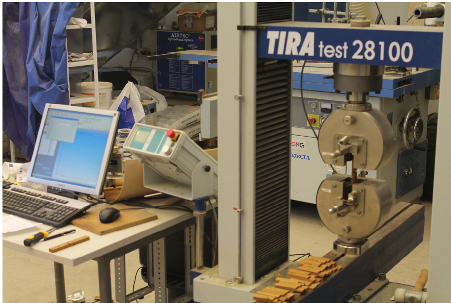
KUVA 6. TIRA test 28100 – aineenkoestuskone.
