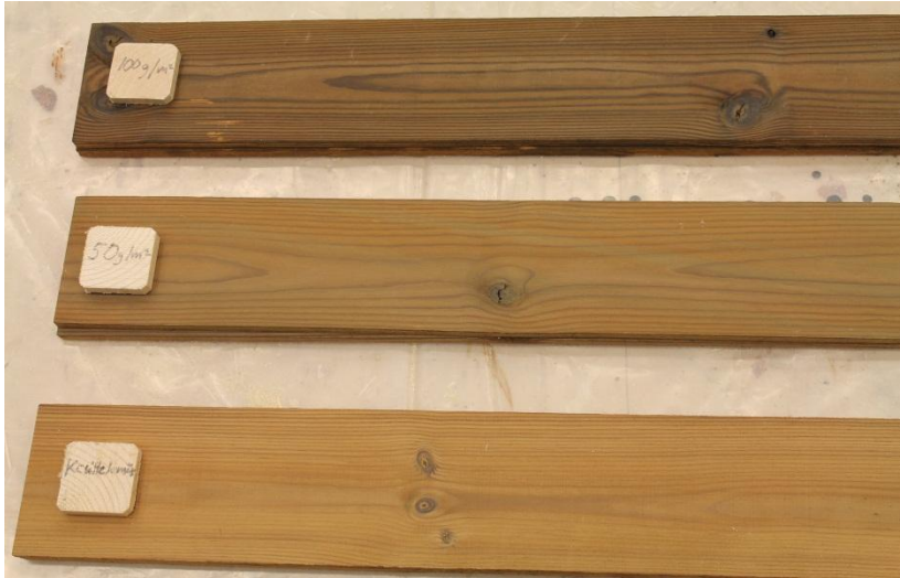
KUVA 3. Liimaamattomat puutisleellä käsitellyt ja käsittelemättömät koekappaleaihiot. Kuva Anssi Koivumäki 2012
