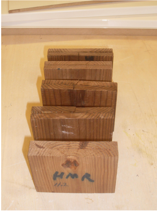
KUVA 13. Keittokoe-kappaleita 8 tunnin keiton jälkeen. Kuva Anssi Koivumäki 2012
