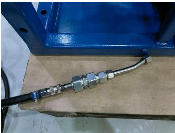
Kuvio 10. Tehdastestissä käytetty liitin järjestelmän paineistamiseen.
