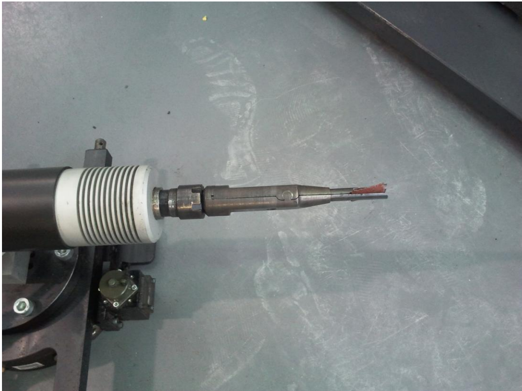
Kuva 2. Robotin työkalu, joka pitää hiomapaperin kiinni.
