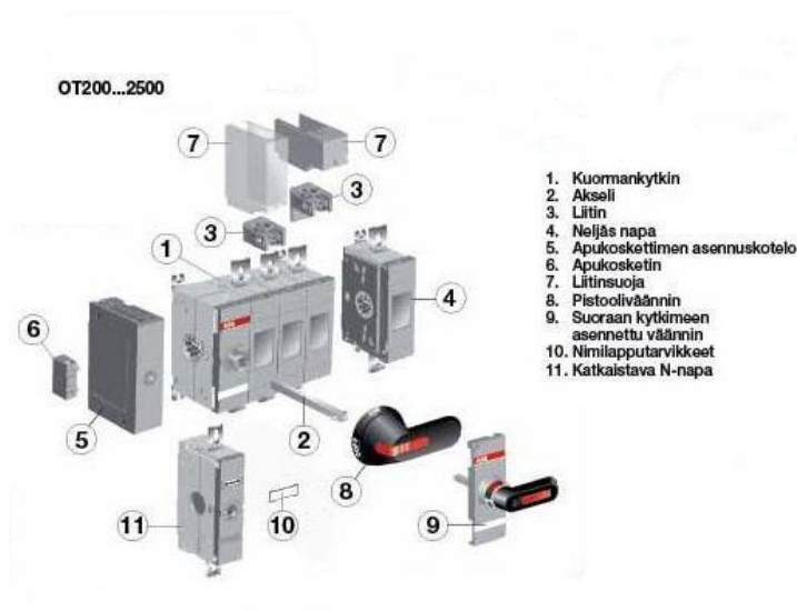
Kuva 31. OT200...2500 kuormankytkin mallien räjäytyskuva. /4/
