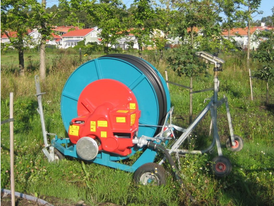
KUVA 3. Uusi sadetusautomaatti Espoon kaupunginpuutarhalla
