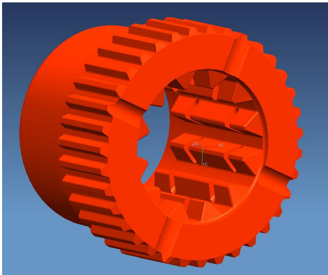
Kuva 8.1. Uusi kytinkappale kuvattuna vinosta
