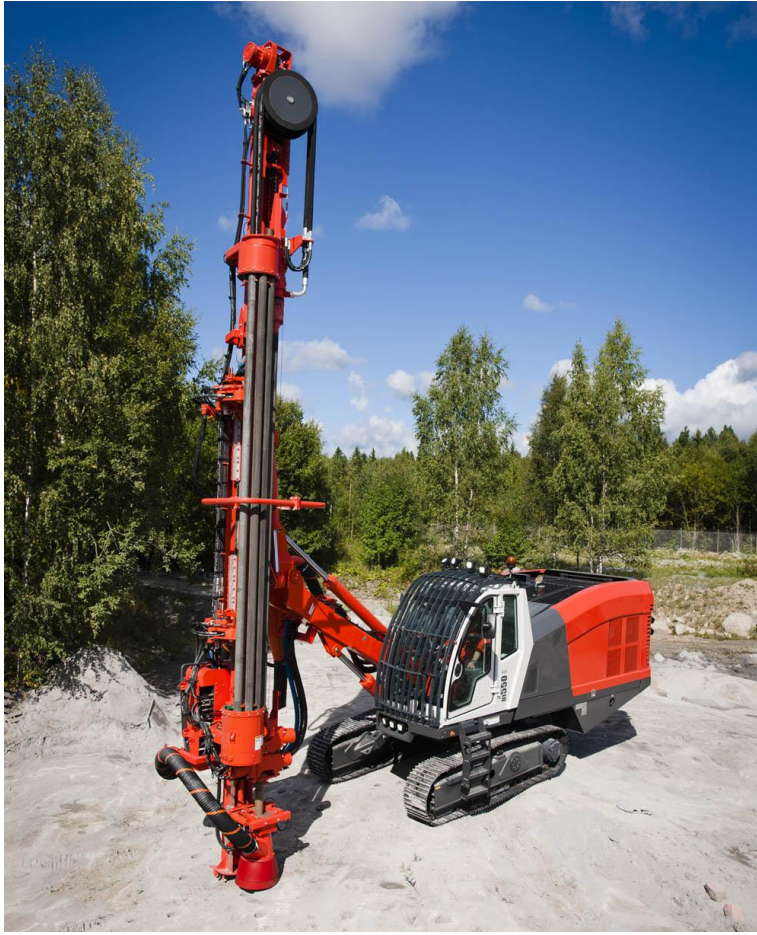
Kuva 3.1. Maanpäällinen porauslaite DI550 /1/
