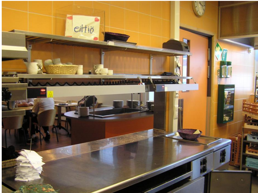
KUVA 37. Uudet lämpöelementit ja hyllyt (Niemelä 2012)
