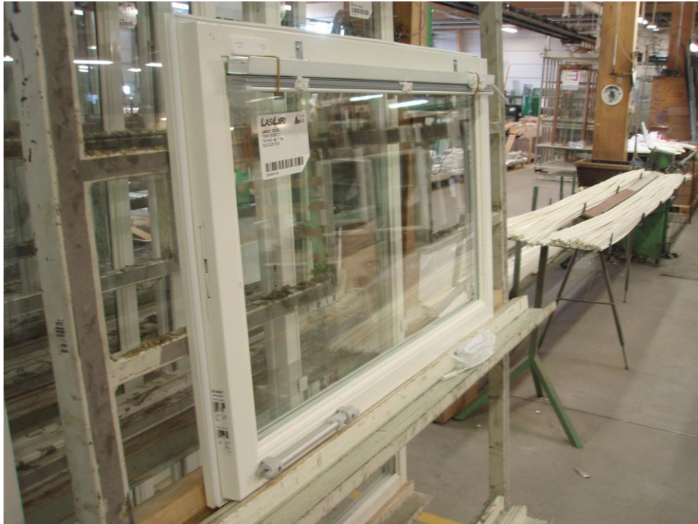
KUVIO 4. Tuuletusikkunan aukipitomekanismi.
