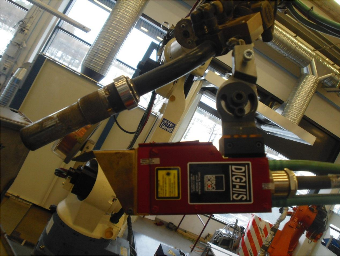
KUVA 13. Servo- Robot DIGI-I/S optinen railonseuranta anturi (Pulkkinen 2012)
