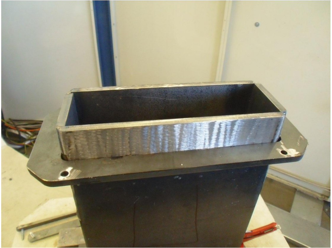
KUVA 5. Säiliön ja hitsauskiinnittimen kiinnityskohta (Pulkkinen 2012)
