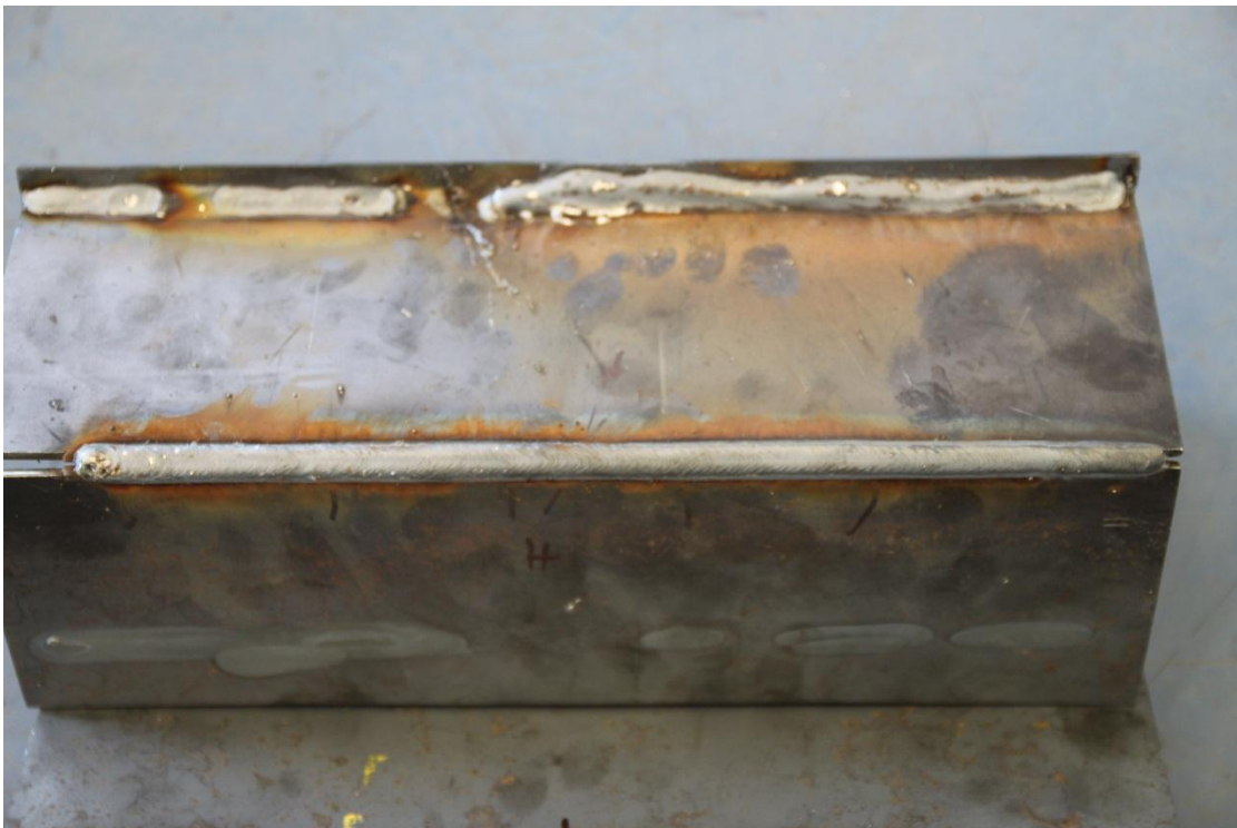
KUVA 19. Kulmarailon hitsaus optisella railon seurannalla (Pulkkinen 2012)
