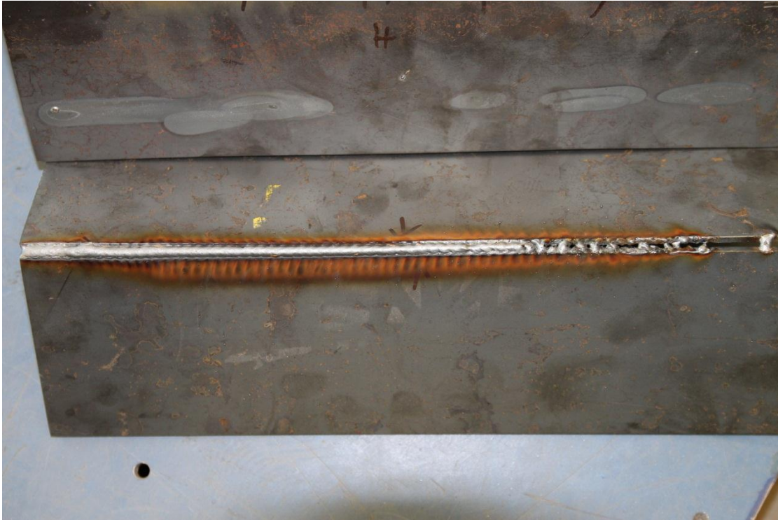
KUVA 18. Kulmarailon hitsaus robotin railon seurannalla (Pulkkinen 2012)
