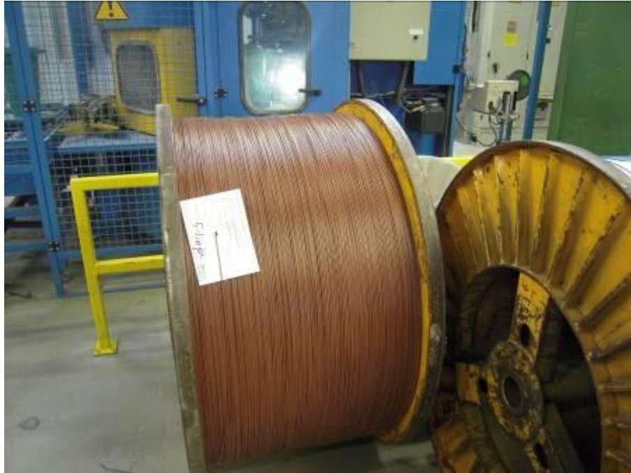
Kuva 6. Eristyslinjalla valmistettu kaapeli.
