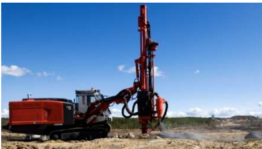
KUVA 1. Päältäiskevä pintaporauslaite DPi (Sandvik Mediabase 2012)
