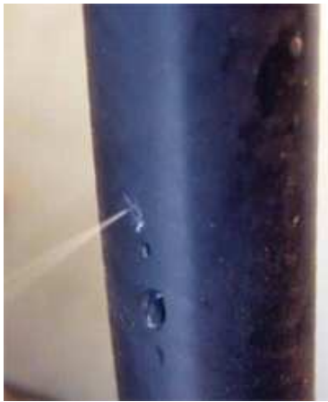
KUVA 3. Pinhole-vuoto letkussa (Hoseandfittingsetc 2012)
