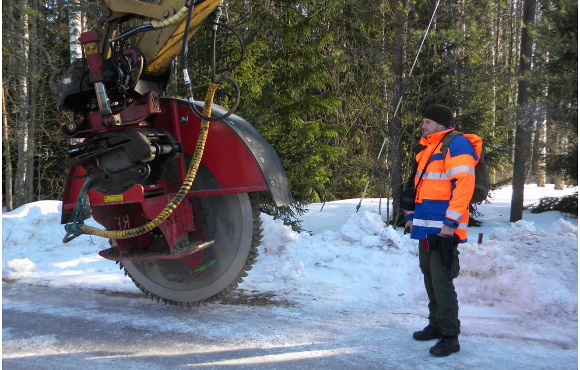
Kuva 7. RF-Systemin pyörösaha kaivinkoneeseen kiinnitettynä Vehmaalla.
