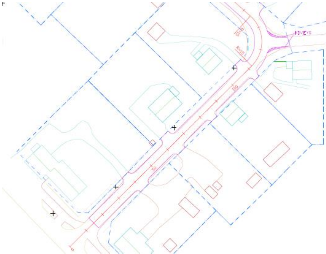
Kuva 3. Mittalinjan ja uuden tien sijoitus paalulukemilla 0-140
