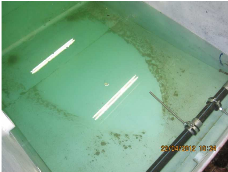
Kuva 36. Pyöreän reiän muodostama virtauskuvio
