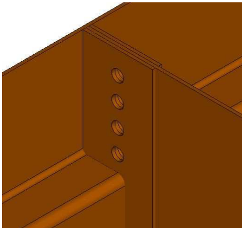
Kuva 9. Altaan väliseinän kiinnitys yläosa
