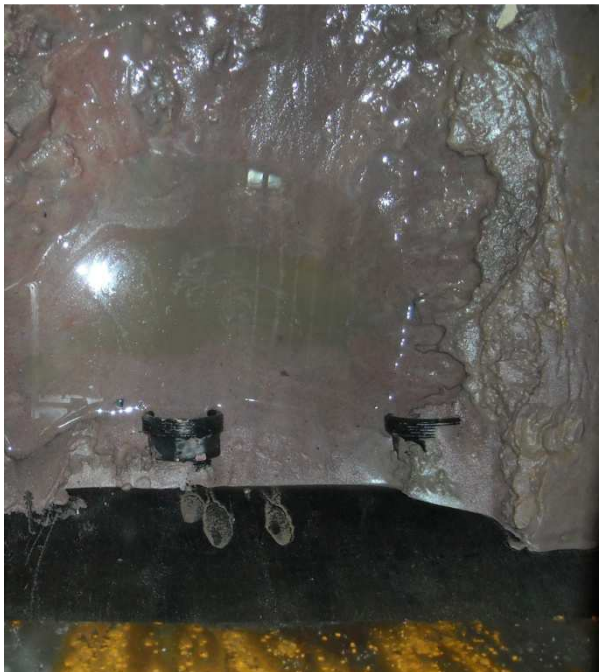
Kuva 3. Abrasiivin tukkeuttama muototeräallas /1/
