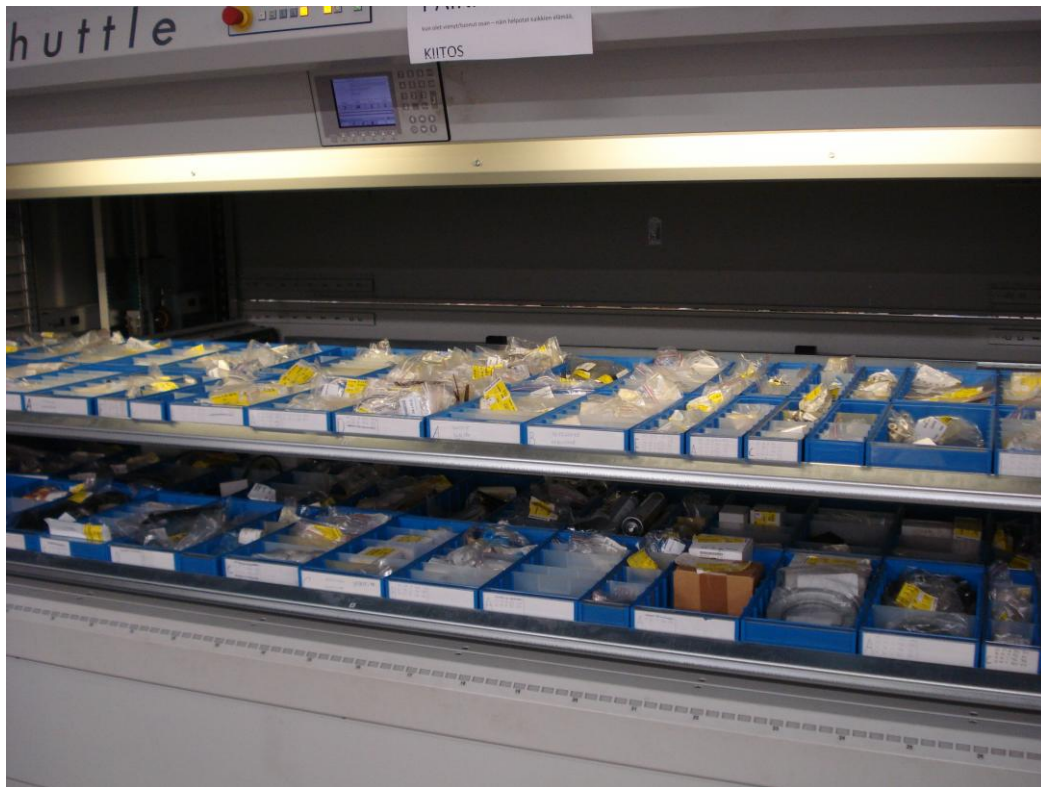
KUVA 19. Automaattikäytössä hyllytasot ovat kahdella eri korkeustasolla (Kuva: Juha Mäkinen 2012)
