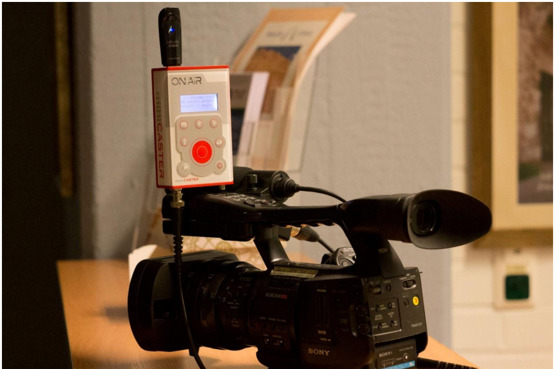
Kuva 4. miniCASTER ja Sony XDCAM EX1-videokamera.
