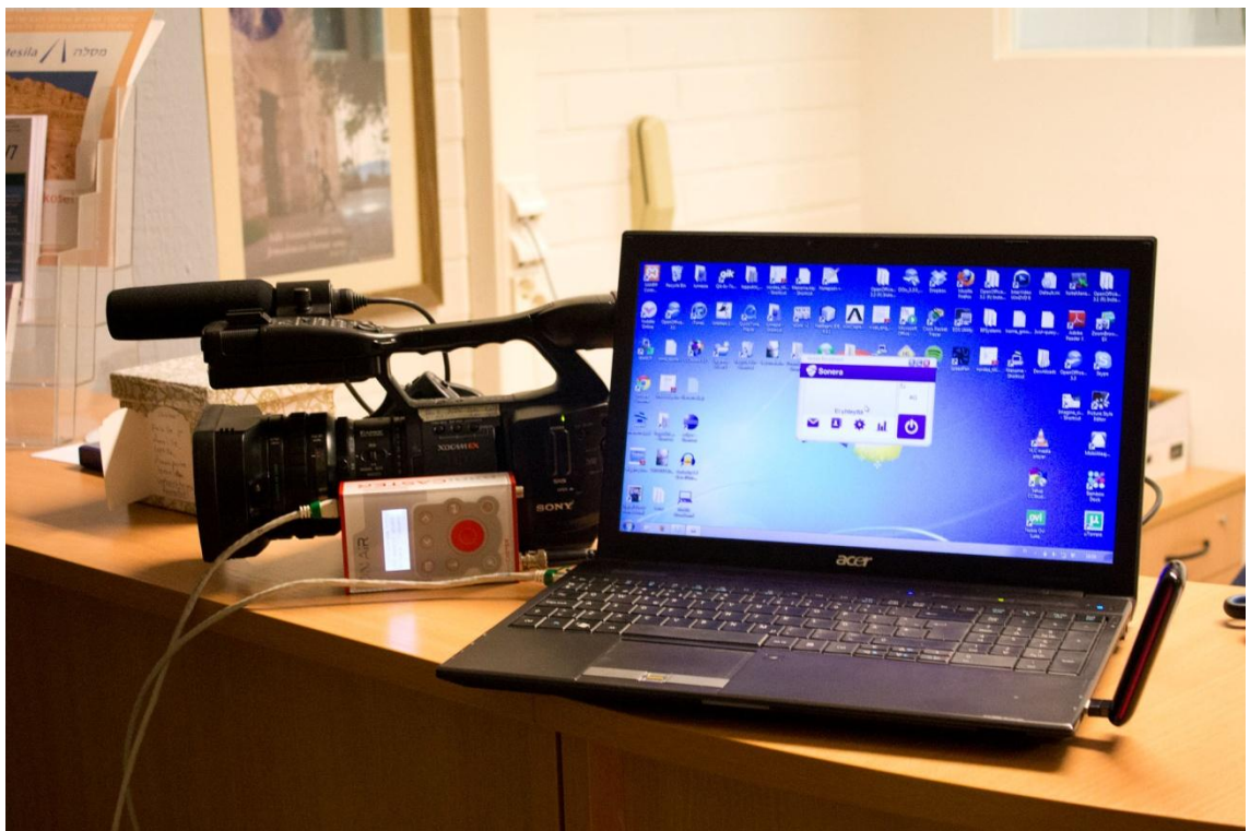
Kuva 12. miniCASTER striimaa 4G-verkkoon kannettavan tietokoneen välityksellä Sony XDCAM EX1-videokamerasta.
