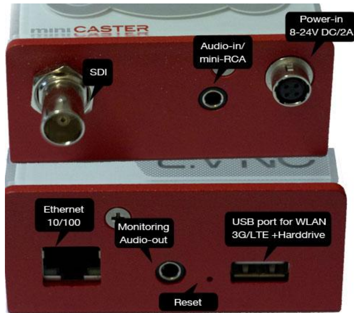
Kuva 6. miniCASTER-laitteet sisääntulot (ylhäällä) ja ulostulot (alhaalla).
