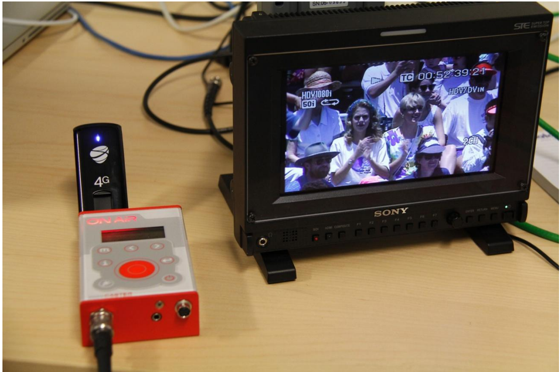
Kuva 9. Kuvassa on miniCASTER, jonka USB-väylässä on ZTE MF820D-nettikku ja kuva tulee Sony HDV-nauhurista, Sony STE monitorin kautta kierrätettynä SDI-signaalina. (Nauhuri ei näy kuvassa.)
