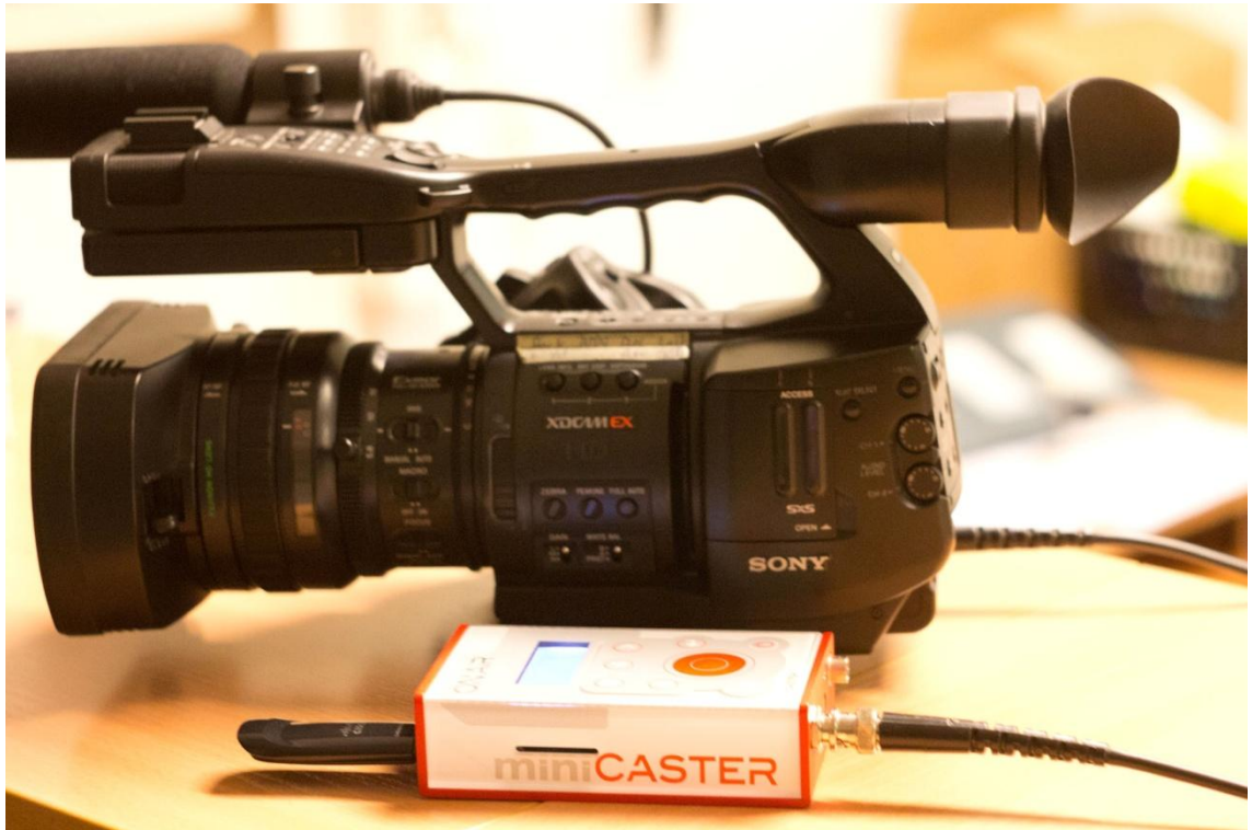
Kuva 8. miniCASTER, jossa on Cisco AE1000 WLAN-tikku kiinni USB-väylässä ja Sony XDCAM EX1 videokamera liitetty SDI-sisääntuloon.
