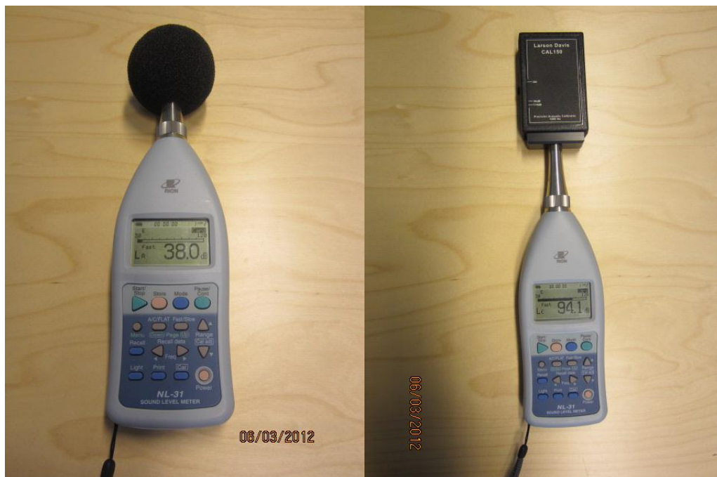
KUVA 4. Rion NL-31 äänitasomittari ja ulkoinen kalibrointilähde (Lohko 2012)
