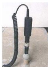
6b. Mittapään tai mittapään johdon ja putken väli tiivistetään välittömästi ja huolellisesti vesihöyryntiivillä kitillä tai tarkoitukseen valmistetulla tiivillä tulpalla. Mittapään annetaan tasaantua reiässä mittapääle ominaisen ajan, yleensä 1...4 tuntia.
