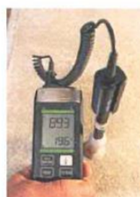
6c. Riittävän tasaantumisen jälkeen näyttölaite kiinnitetään mittapäähän ja kosteusarvo luetaan näyttölaitteen näytöltä.
