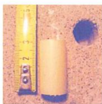
5a. Reikä porataan ja puhdistetaan kuvan 3 mukaisesti. Reikään asennetaan reiän syvyyden pituinen mittausputki tai putki katkaistaan betonipinnan tasolta.
