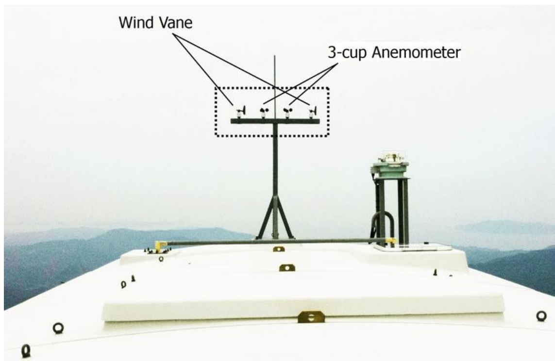
Kuva 11. Tuulivoimalan katolla sijaitsevat tuuliviirit ja anemometrit [26].
