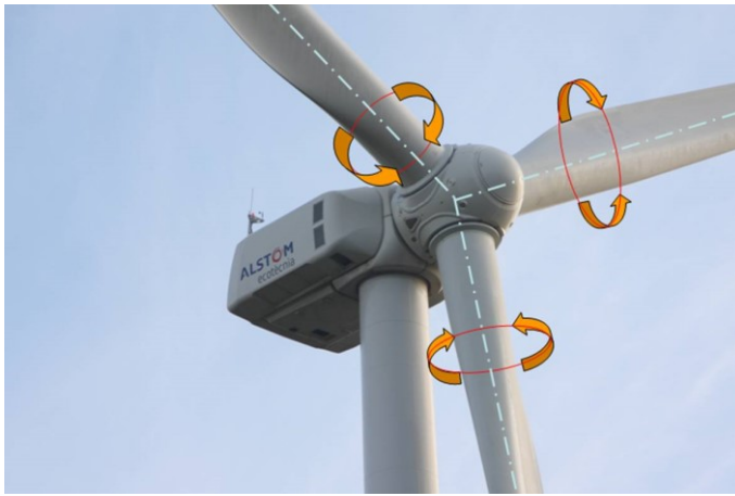
Kuva 7. Lapakulmansäätöisissä turbiineissa lapoja käännetään niiden pitkän akselin ympäri tehon säätämiseksi [19].
