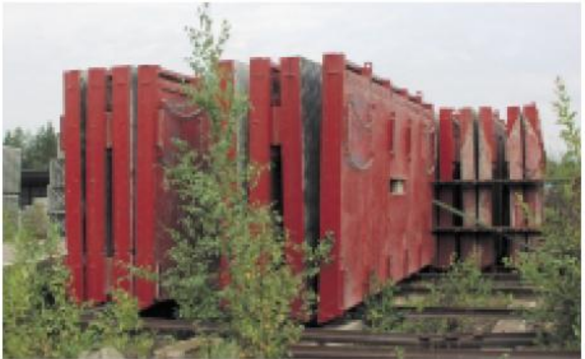
Kuva2. Suurmuottien oikeaoppinen varastointitapa kampatelinettä käyttäen. [6.]
