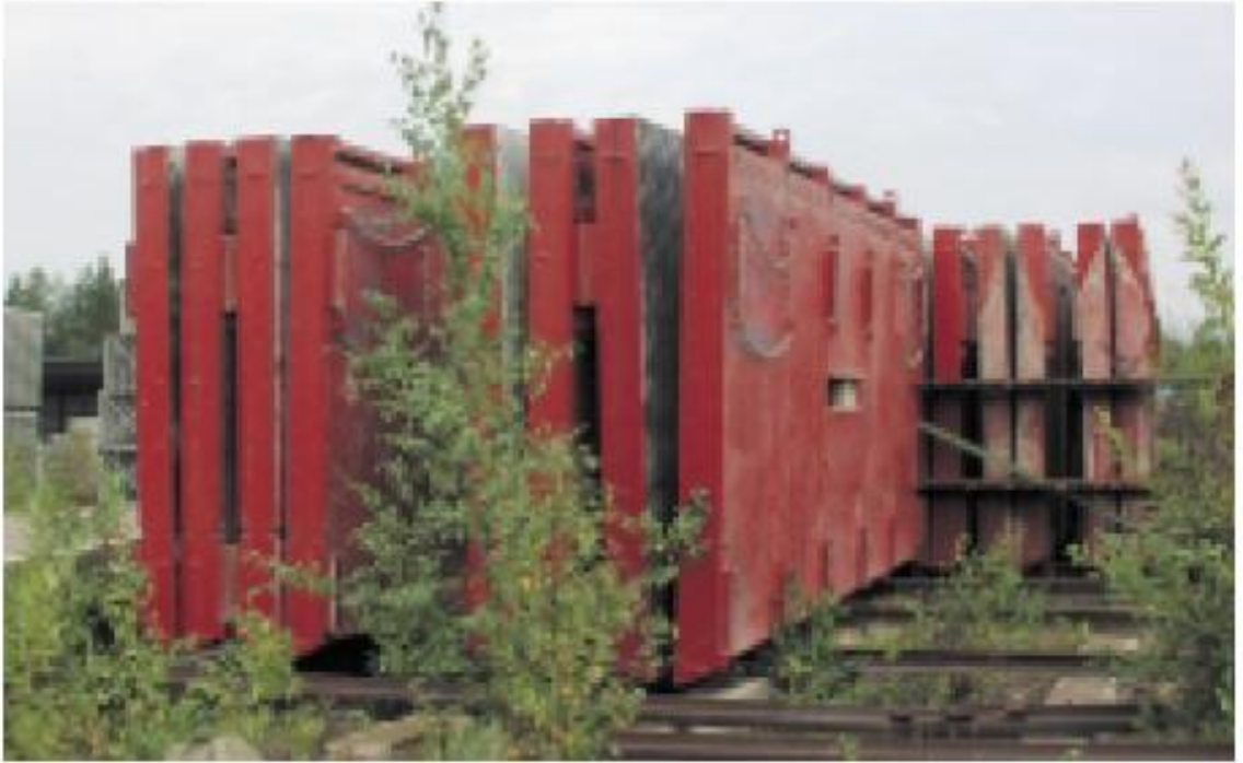
Kuva 28. Suurmuottien oikeaoppinen varastointitapa kampatelinettä käyttäen. [14.]
