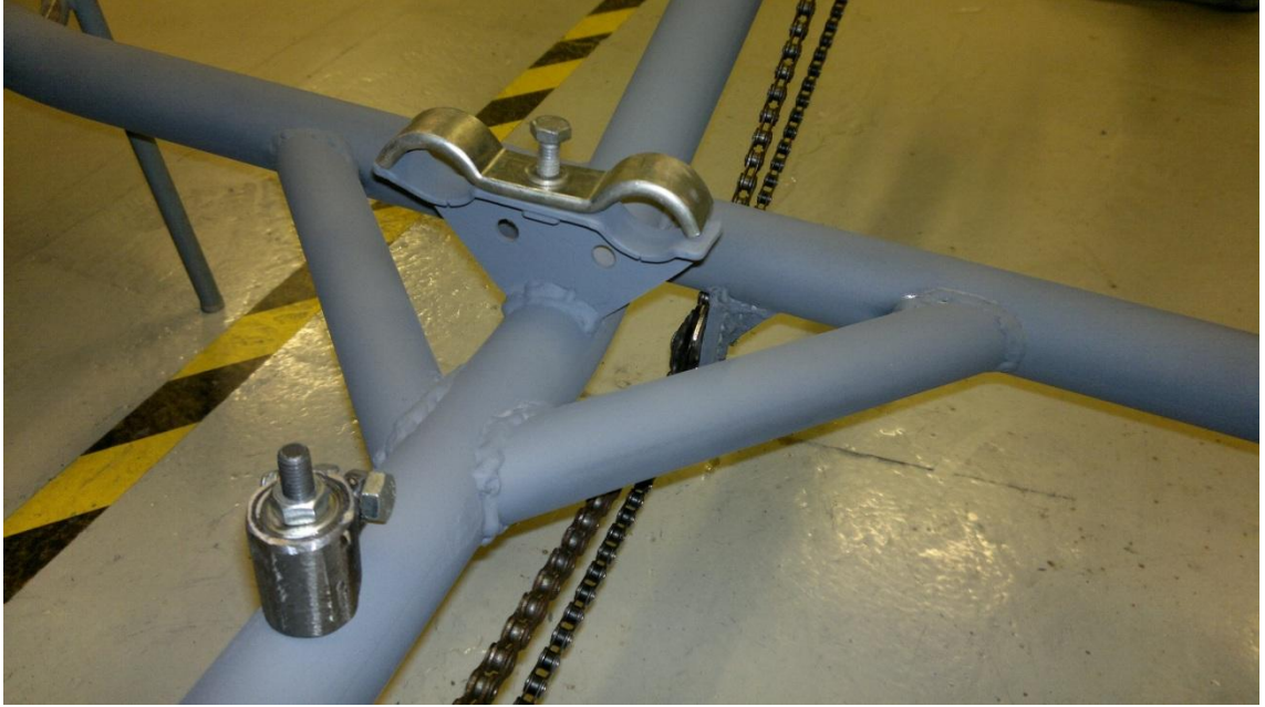
Kuva 32. Etuputken ja runkoputken liitosta tukevat putket.
