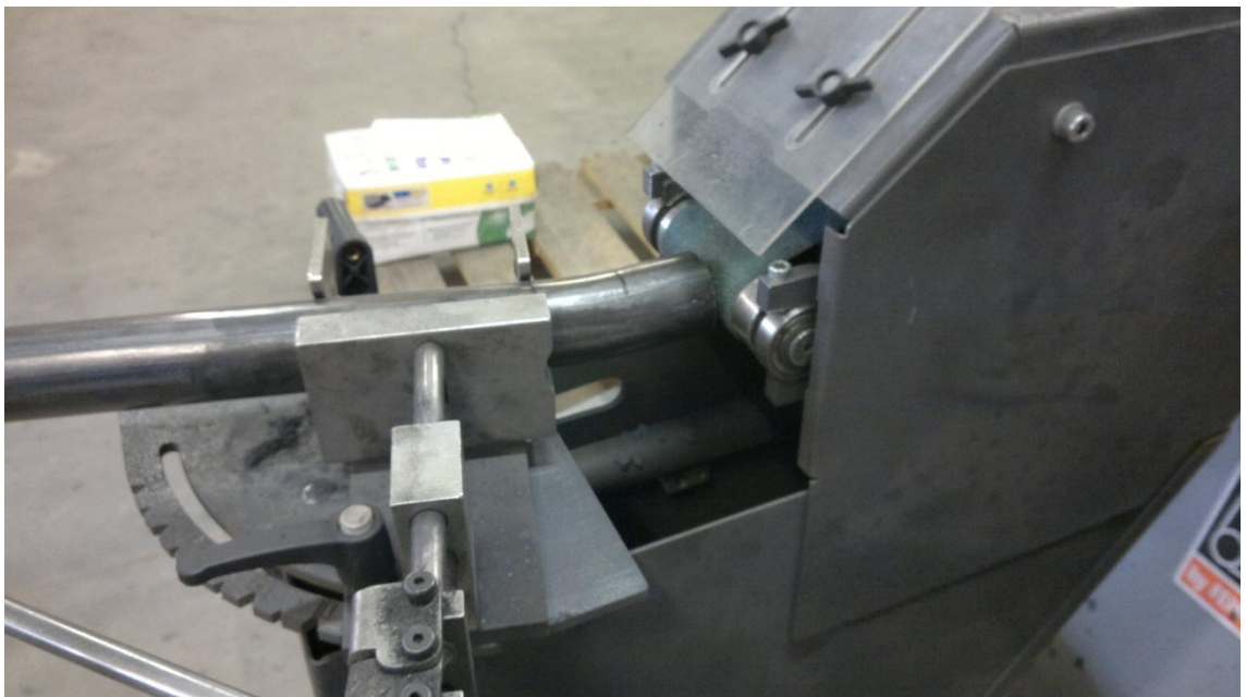
Kuva 29. Etuputken päädyn hionta olkatapin laakeripesälle.
