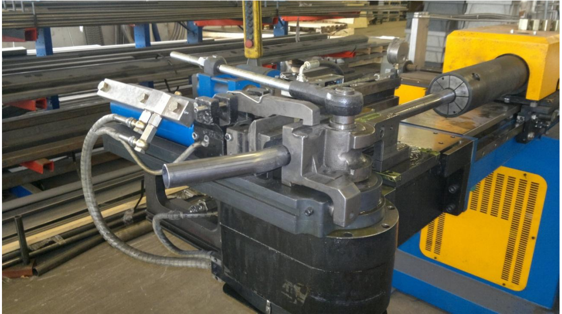
Kuva 28. Takahaarukan putken taivutus CNC-ohjatulla putkentaivutuskoneella.
