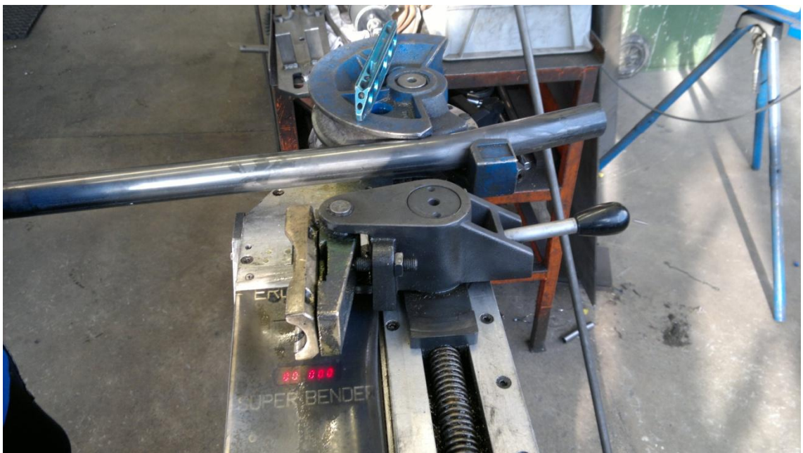
Kuva 27. Etuputken taivutus hydraulisella putkentaivuttajalla.
