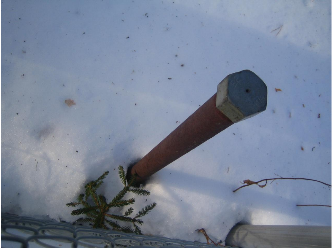
Kuva 3. Pohjaveden tarkkailuputki. Valokuva Linda Luostarinen 2012.
