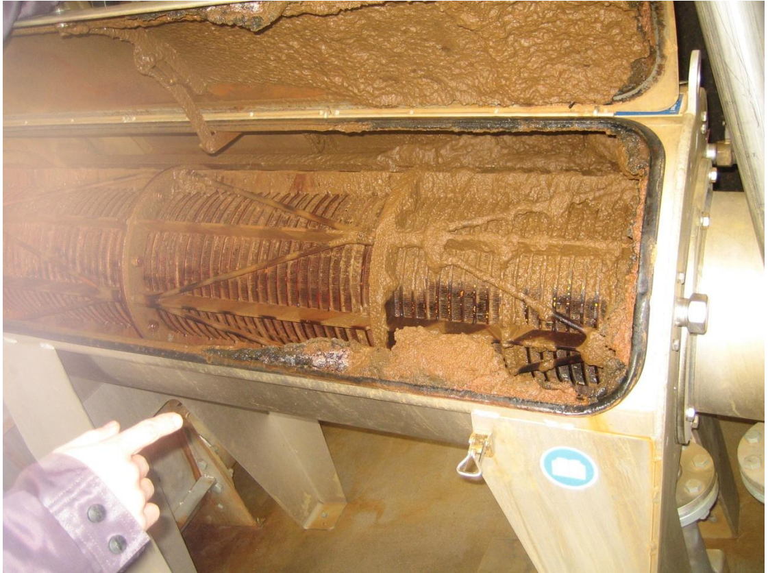
Kuva 9. Lietteen kuivaus tehdään ruuvikuivaimella. Valokuva Linda Luostarinen 2012.
