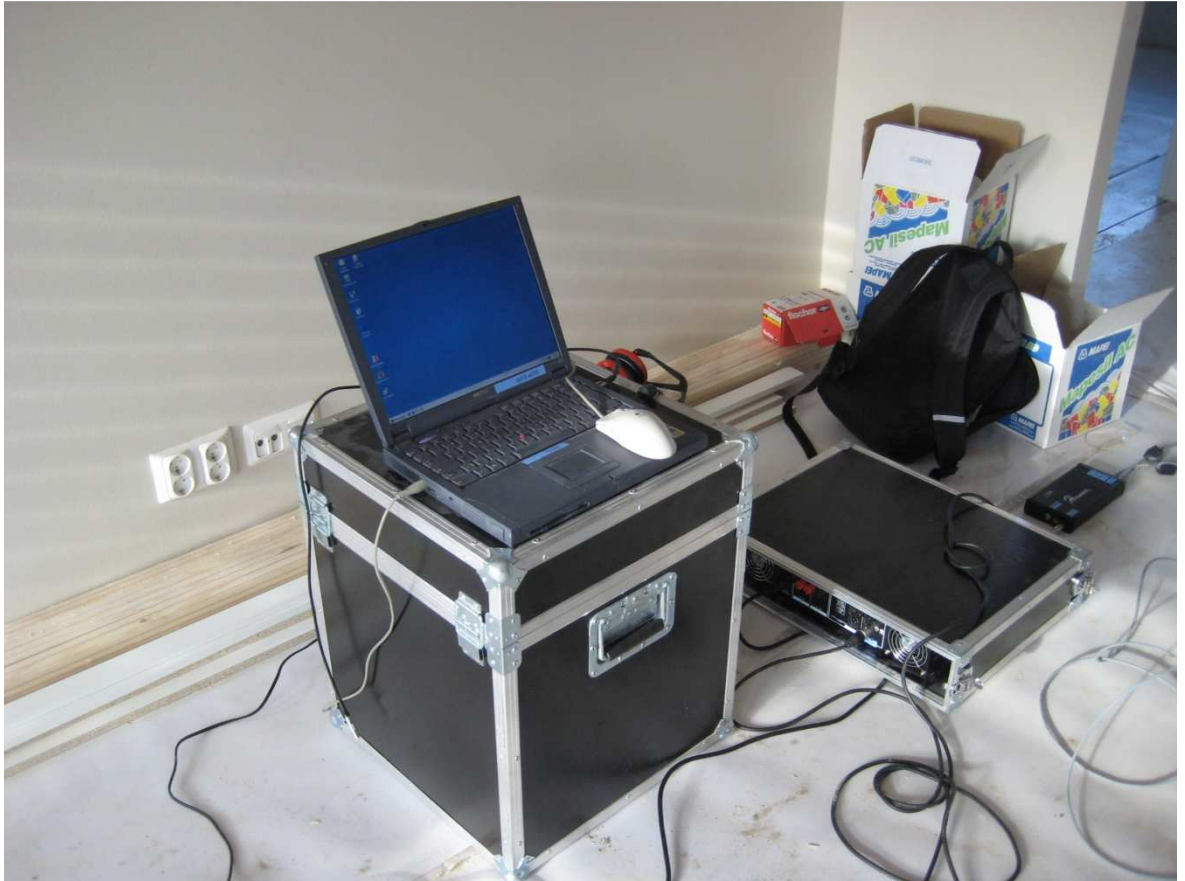
Kuvio 19. Mittauslaitteisto: kannettava tietokone, vahvistin ja Harmonie yksikkö
