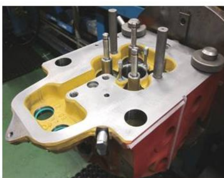
Sylinterikansi yläpuolelta, venttiilit lukittuna
