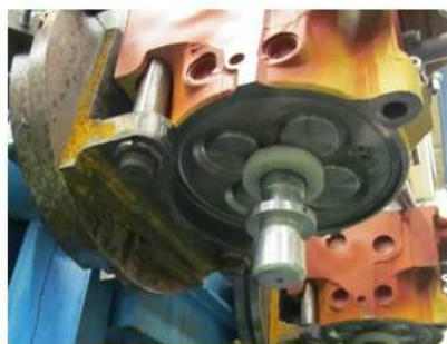
Venttiilit lukittu istukkapintaan laipan avulla
