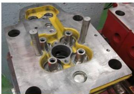
Ohjainholkit kiinnitetty sylinterikanteen
