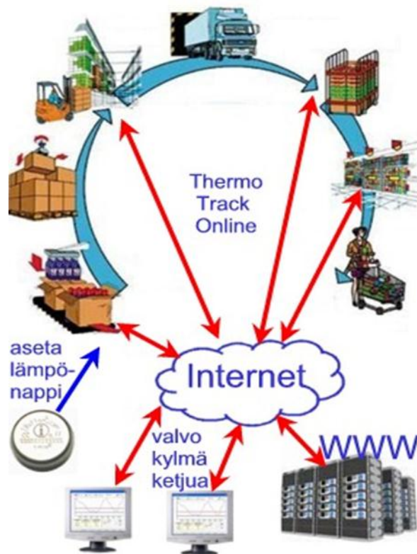
Kuva 6. Loggerin toiminta. Thermo Track Online -malli. (Ekoweb 2012).
