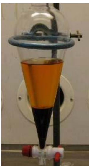
KUVA 26. Erotussuppiloon tehty biodiesel ja pohjalle laskeutunut glyseroli
