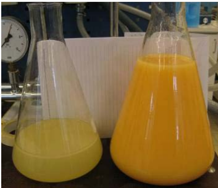
KUVA 27. Vasemmalla pesuvesi ja oikealla biodiesel
