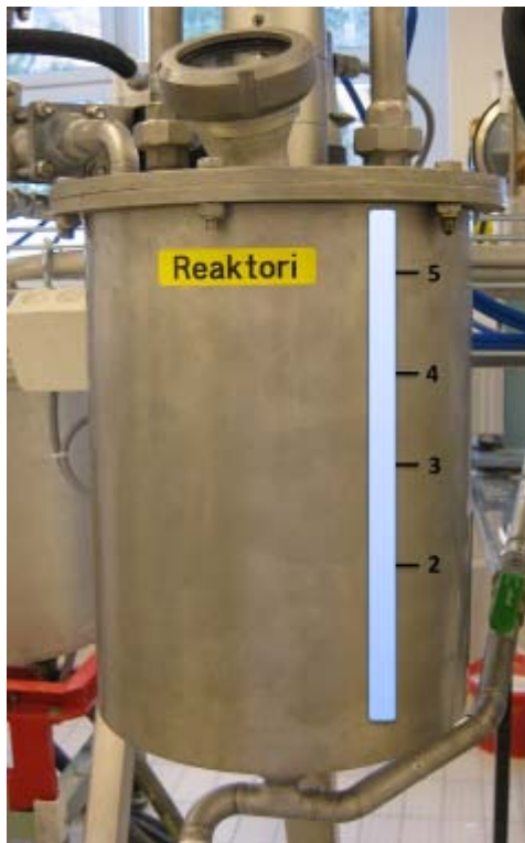
KUVA 39. Näkölasi ja mitta-asteikko reaktorin kyljessä
