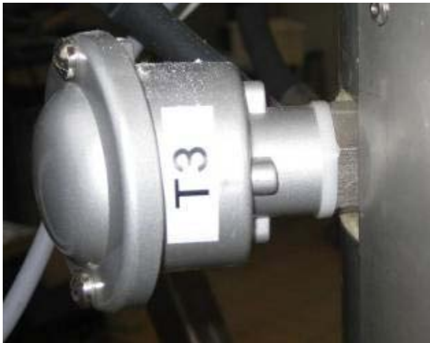
KUVA 6. Reaktorin lämpötilamittarin vaipan ulkopuolinen osa
