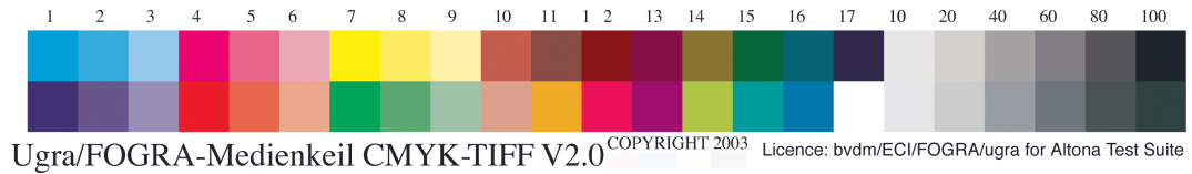
Kuva 11. Ugra/Fogra Media Wedge V2.0 muodostuu 46 väriruudusta, joista voidaan mitata ja verrata arvoja CIELab-referenssiarvoihin. Eron keskiarvoa mitataan \Delta E -arvolla. [17, s. 44.]
