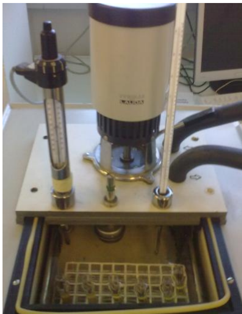
KUVA 12. Same- ja jäähmepisteen mittausjärjestelyt
