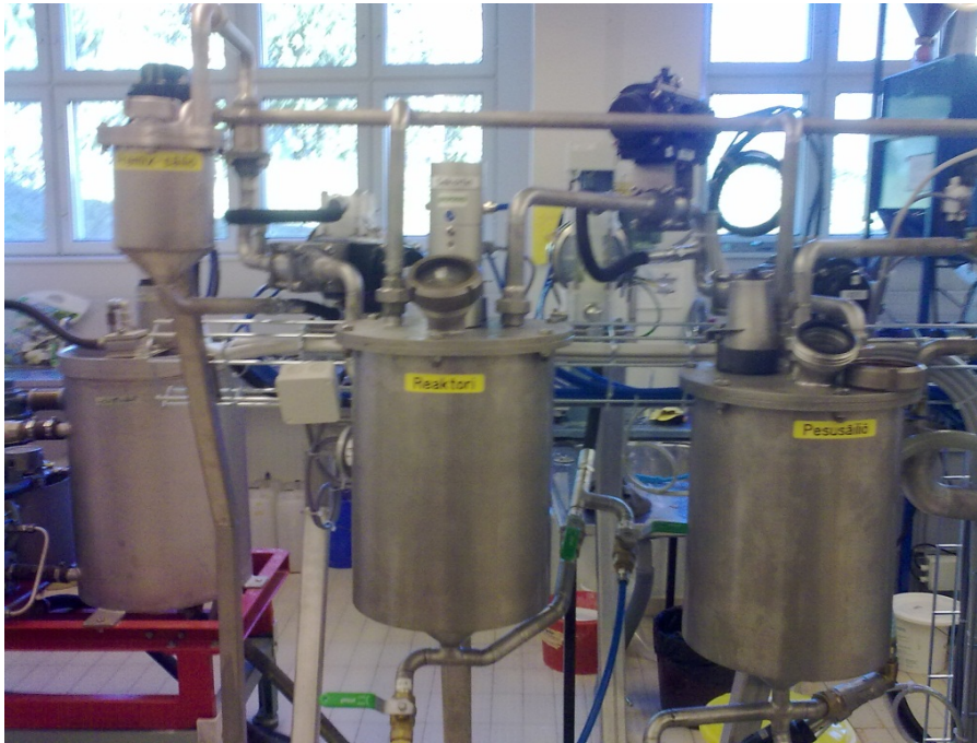
KUVA 1. Biodiesel laitteisto, vasemmalta oikealle: premix-säiliö, reaktori ja pesusäiliö
