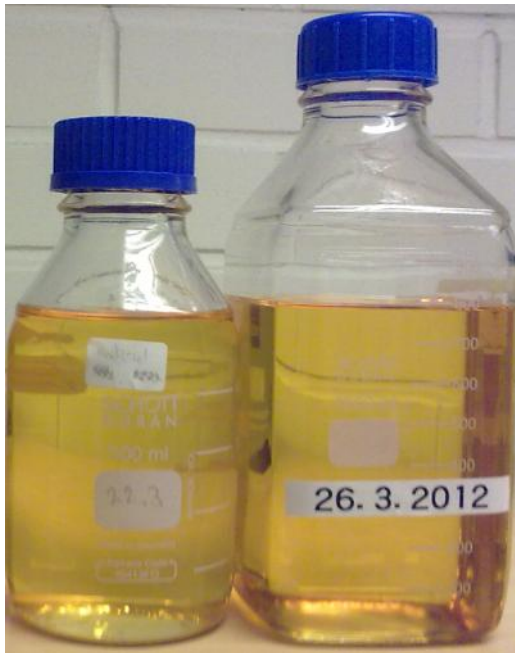
KUVA 2. Esteripitoisuuden vaikutus biodieselin ulkonäköön
