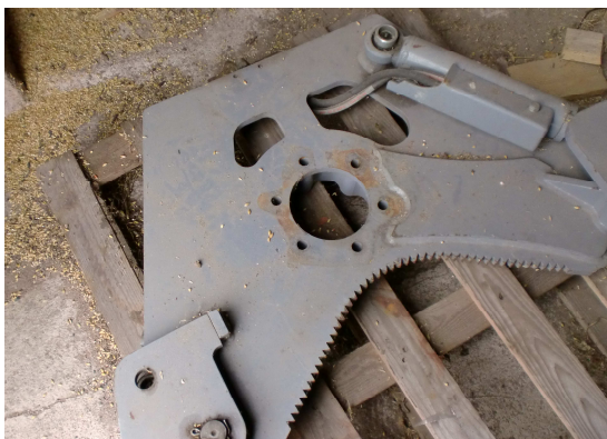
Figur 3. Ackumuleringsutrustningen fästs med bultar under aggregatet. Foto JT
