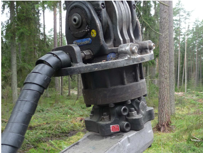
Figur 2. För att stammarna skall hållas upprätta medan man ackumulerar eller hämtar ut stammarna till körstråket behövs en kraftig broms vid rotatorn. Foto JT.
