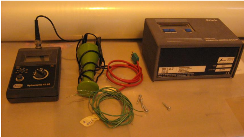
Kuvio 15. Lämpötilaa ja kosteutta mittaava laitteisto.
