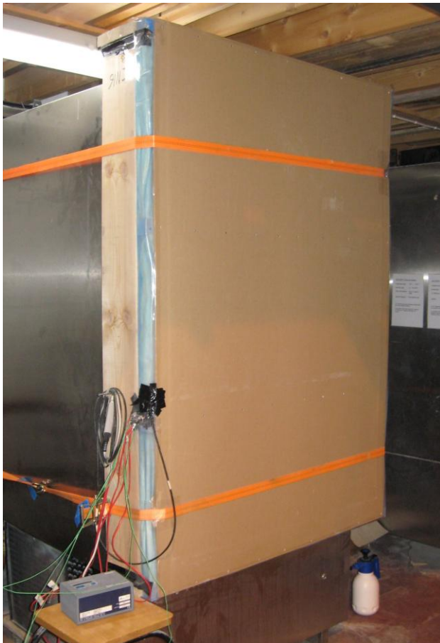
Kuvio 14. Koeseinä kiinnitettynä sääkaappiin (Arctest ARC 1500).
