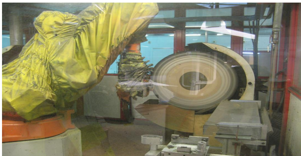
Kuva 2.2 Kiillotussolun robotti työssä DAN3- linjastolla.
