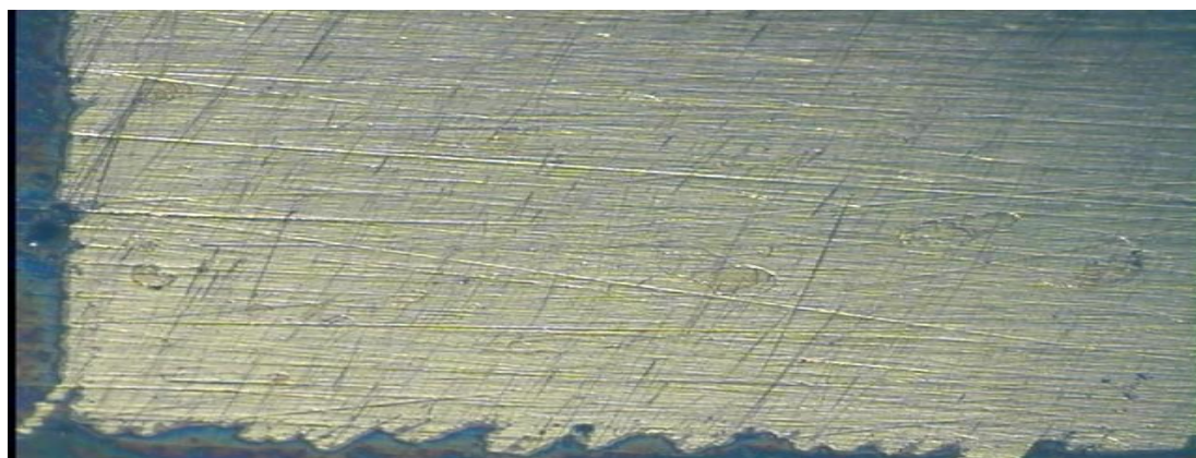
Kuva 7.2 Pinta ultraäänipesun jälkeen
