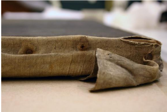
Kuva 14. Kankaan suurimmat vauriot ovat kankaan pingotusreunassa: osa nauloista on ruostunut kankaan läpi ja kiilakehyksen terävä kulma on hangannut kankaan puhki.
