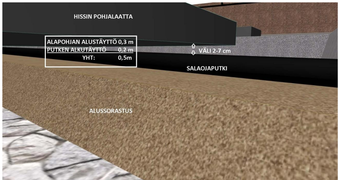
KUVA 29. Hissin lattialaatan ja salaojaputken väli on liian pieni
