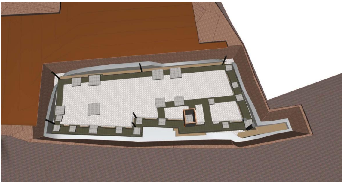
KUVA 14. Väliseinien anturan alustäyttö, hissien seinät ja lattian alustäyttö.
